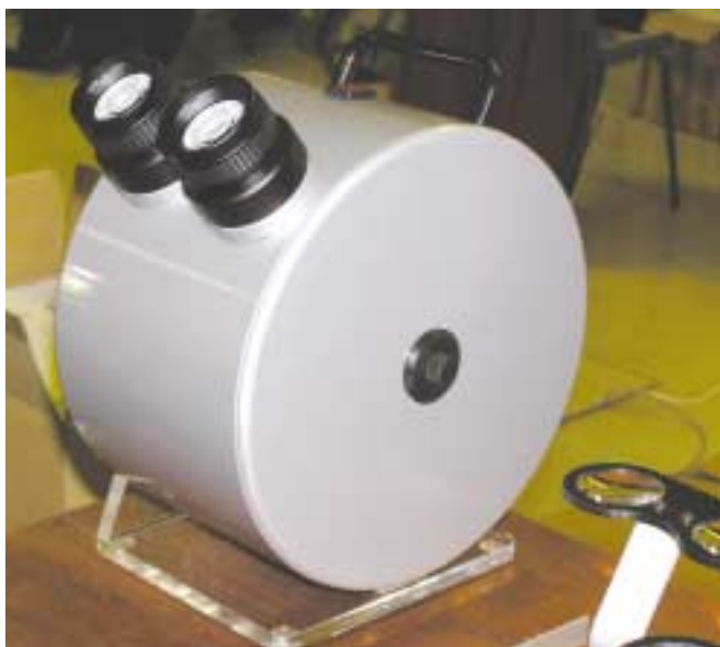
▲ Velmi jednoduchý prohlížeč 3D diapositivů. Na malém bubnu se nachází páry příslušných fotografií, které divák sleduje díky očnicím. Celý systém pracuje bez elektrické energie.
