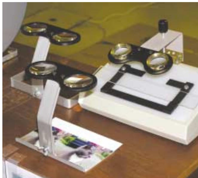
▲ Jeden z mnoha jednoduchých, ale funkčních 3D prohlížečů. Dvojici fotografií stačí pouze položit pod dvojici skel a můžete pozorovat.
