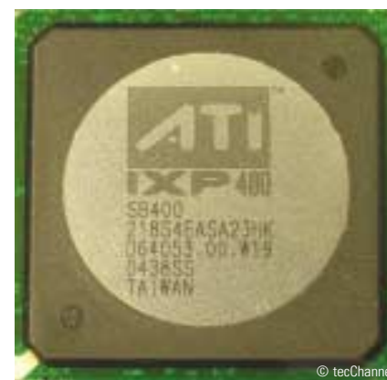
▲ IXP400: ATI Southbridge nabízí pouze standardní funkce.
