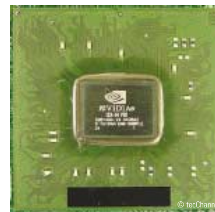
▲ Čipset od nVidia nForce4 pro procesory Athlon je integrován v jednom čipu.
