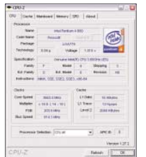
▲ Práce na plný výkon: 3 600 MHz při 1,51 V.
