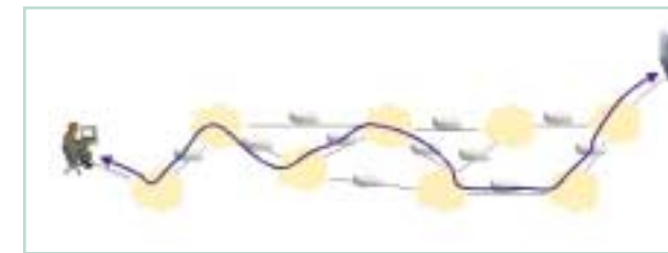
◀ Představa fungování síťové vrstvy: doručuje síťové pakety až k jejich koncovým příjemcům.
