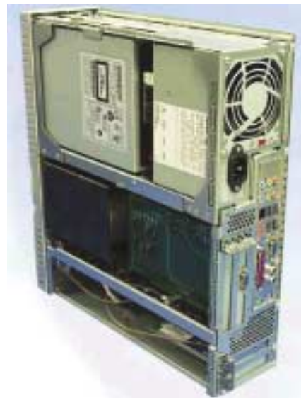
▲ Zadní pohled: obrázek zobrazuje zadní stranu skříně systému Micro BTX. Uspořádání větracích otvorů podporuje chlazení komponent ve skříně.
