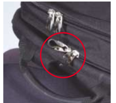
▲ Částečná destrukce očka.
