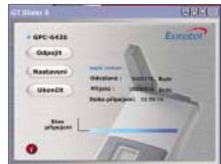
▲ GT Dialer se stará o komunikaci s modemem, připojuje a odpojuje internet a zároveň ukazuje základní statistiku přenosu.
