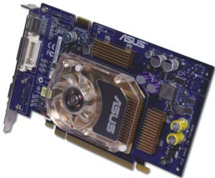
▲ Grafická karta PCI Express: výrobci grafických čipů již pracují na prvních prototypch grafických karet s rozhraním PCI Express (zdroj: Intel).
