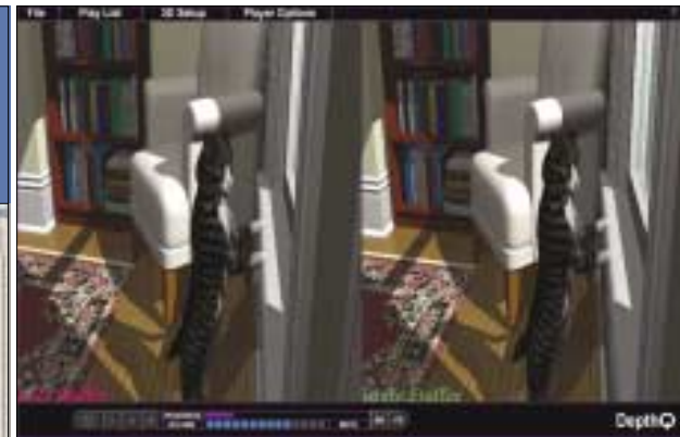
▲ DepthQ nabízí profesionální možnosti přehrávání 3D stereoskopického záznamu. Zde je vidět, že každá 3D scéna se skládá ze dvou samostatných obrazů.
