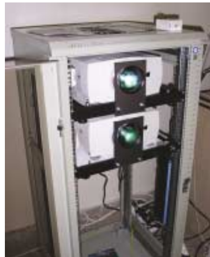
▲ Dvojice projektorů s polarizačními filtry před objektivem. Ke sledování 3D snímku je třeba mít polarizační brýle.
