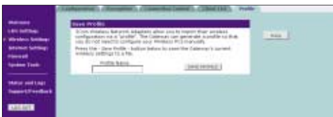
5 Nastavení profilu připojení k bezdrátové síti lze uložit do souboru a přenést do mobilního klienta. Při používání bezdrátových síťových karet 3Com si tak můžete ušetřit práci s manuální konfigurací klientů.
