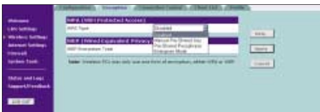
4 K volbě šifrování máte 40- a 128bitový WEP, příp. WPA s možností předsdíleného klíče nebo ověřováním na RADIUS serveru.
