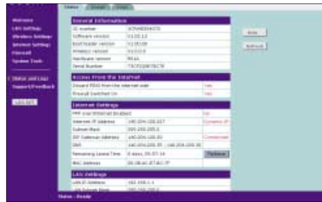
6 Ve statusu zařízení zjistíte aktuální revizi firmwaru brány, IP adresaci na LAN i WAN straně, nastavení bezdrátové sítě a rychlosti na jednotlivých portech brány.
