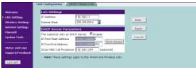
1 Nastavení IP adresace LAN, včetně možnosti vypnutí DHCP serveru. Systém podporuje i IP telefonii 3Com, takže v lokální části sítě lze využívat 3Com NBX IP telefonní ústřednu.
