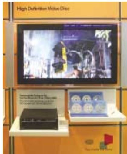
▲ Nevšedním zážitkem bylo sledování videa v HDTV rozlišení, na odpovídající LCD TV. Každý z dole vystavených Blue-Ray disků má kapacitu 50 GB.
