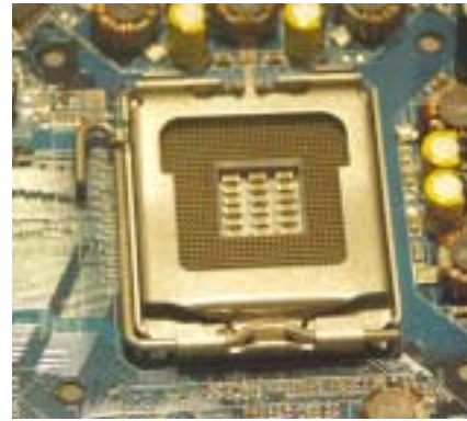
▲ S příchodem patice LGA 775 se „nožičky“ přesunují z procesoru na patici. Znamená to omezený počet „výměn“ procesoru – zvyšuje se riziko ulamování nožiček v patici.
