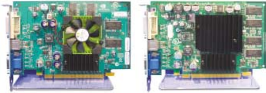
▲ První karty s rozhraním PCI Express postavené na GPU NVIDIA předvedlo hned několik výrobců. Jedná se ale o stávající typy GPU GeForce FX doplněné o „překládací“ čip, který zajišťuje komunikaci s PCI Express rozhraním (ten se skrývá pod menším pasivním chladičem).
