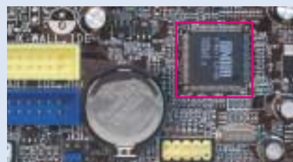
▲ Hardwarový FireWire klíč (nahore) odemyká data kódaná na hard disku za pomoci čipu Enova (dole).
