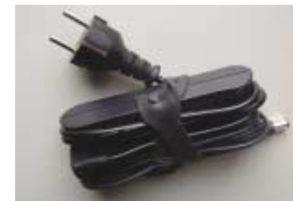
▲ Na gumě, která slouží k uchycení kabelů omotaných okolo AC adaptéru, se po šesti měsících ulomil plastový aretační kolík.
