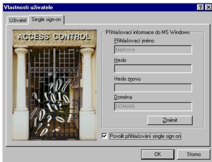
Obr. 57. IW KeyManager - záložka Single sign-on - přenastavení vlastností uživatele, kdy uživatel má použití systému jednotného přihlašování povoleno a nastaveno, z pohledu administrátora.
