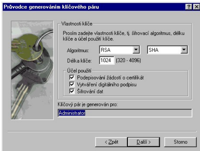
Obr. 67. IW KeyManager - zadání šifrovacího algoritmu, hashovací funkce, délky a účelu klíče pro klíč chráněný heslem
