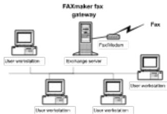
*Abbildung 1 FAXmaker Fax-Gateway läuft auf MS Exchange Server.*
