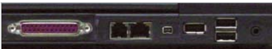
Tre porte Usb 2.0 e una IEEE 1394 garantiscono un'ottima espandibilità nell'E-motion 710
