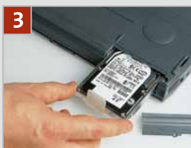
3 Il nuovo disco fisso viene reinstallato completo dei vecchi rivestimenti
