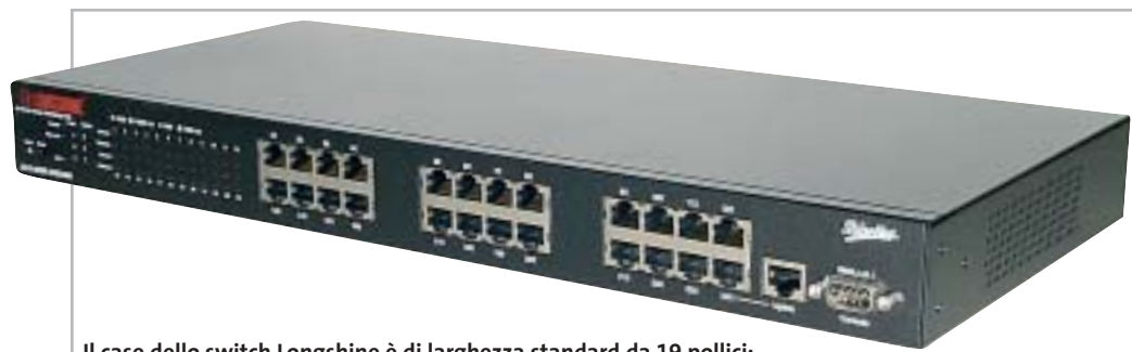
Il case dello switch Longshine è di larghezza standard da 19 pollici: può essere installato in un armadio rack di commutazione o appoggiato su una scrivania
