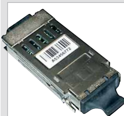
I moduli intercambiabili (Gbic) dello switch AT-9816GB si possono assortire secondo necessità
