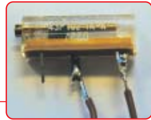
5a Trimmer potenziometrico: permette di dosare finemente la tensione di alimentazione
