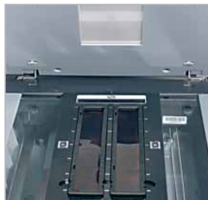
La mascherina fornita con il CanoScan 8000F può ospitare due spezzoni da sei fotogrammi o quattro diapositive
