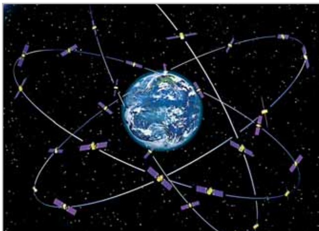
30 satelliti verranno uniformemente distribuiti su tre orbite medie, per coprire l'intero globo terrestre con i segnali radio di localizzazione
