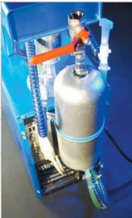
Ciò che prima serviva a fornire acqua sotto pressione a un caravan, ora viene utilizzato come polmone per il raffreddamento ad acqua
