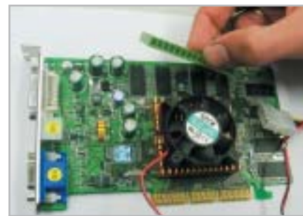
7 Fissare la ventola e i dissipatori delle memorie sulla scheda video GeForce FX 5200
