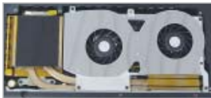
Il sistema di dissipazione è efficace e sufficientemente silenzioso: utilizza un sistema Heat Pipe con condotti in rame, spalleggiato da una coppia di ventole
