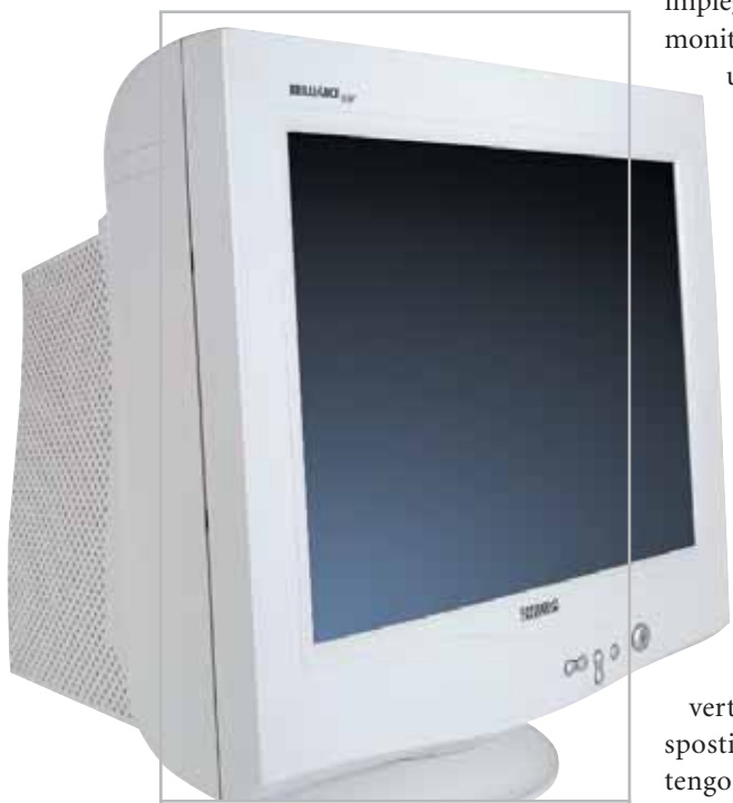
1 Come tutti i monitor a tubo catodico con maschera a griglia verticale, il Philips 109P mostra due sottili righe nere orizzontali
