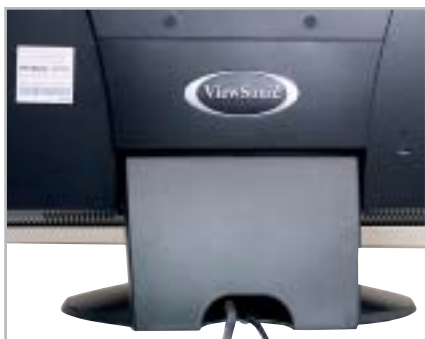
Elegante anche da dietro: due mascherine in plastica nascondono alla vista i connettori del monitor ViewSonic
