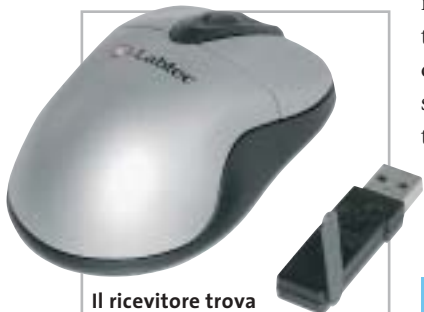
Il ricevitore trova alloggio nella parte inferiore del mouse
