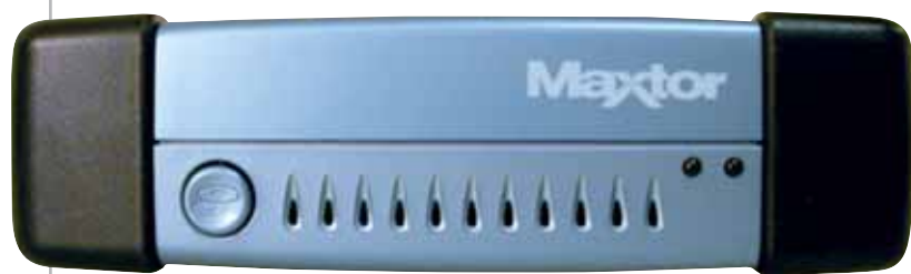
Il pulsante frontale presente sul Maxtor 5000DV permette di effettuare il backup dei dati
