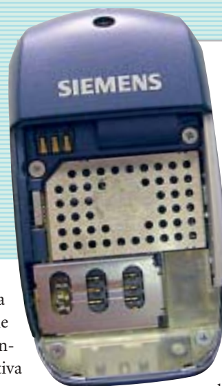
Il vano batteria e porta-Sim card: rimuovere la scheda è un'operazione un po' macchinosa
