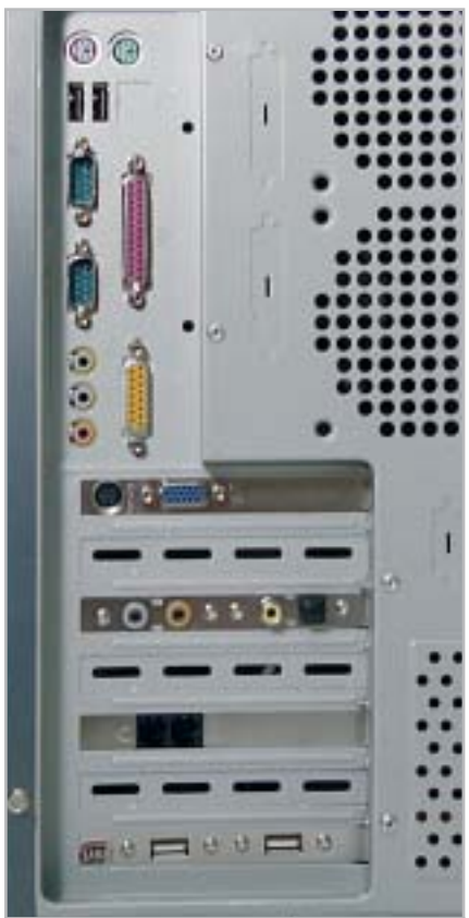
L'ottima dotazione di porte del pc di Esegi Informatica: si noti la presenza di uscite S/Pdif ottica e coassiale
