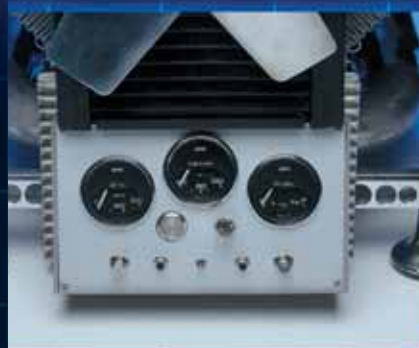
Centrale di controllo: il "cruscotto" dell'AMD Big Block è stato prelevato da una Lotus del '69, che visualizza il numero di giri della ventola, la tensione di alimentazione e la temperatura dell'acqua
