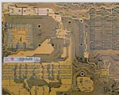
La distribuzione dei piani di massa gioca un ruolo fondamentale nella qualità complessiva della motherboard
