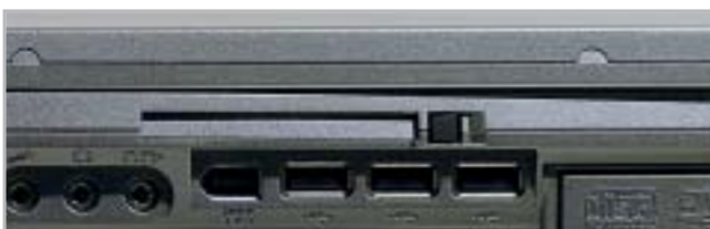
Il notebook di Elematica monta tre porte Usb 2.0 e una firewire a 6 pin
