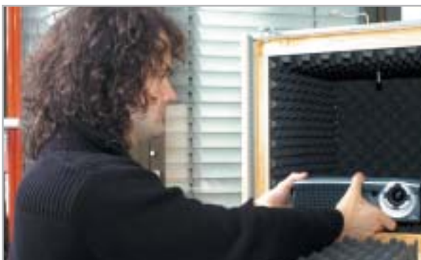
Test di ascolto: Josef Reitberger, del CHIP Test Center, mentre attrezza il box anecoico
