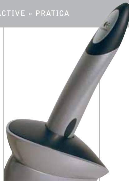
Il calamaio è una docking station che ricarica la penna e si interfaccia con il pc
