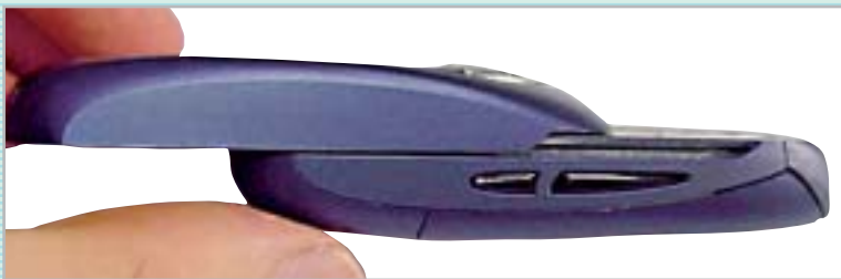
Per far fuoriuscire la piccola tastiera basta agire sui due semigusci con due dita, esercitando una lieve pressione
