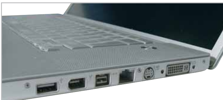
Dotazione di porte completa: si notino la firewire e l'uscita digitale Dvi per connettere pannelli Lcd
