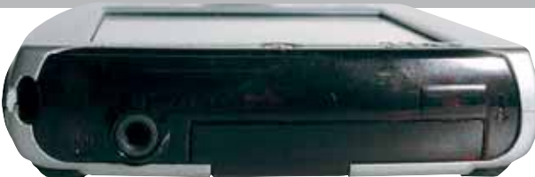
Sull'Axim X5 sono presenti sia uno slot CompactFlash sia uno per moduli Secure Digital/Mmc
