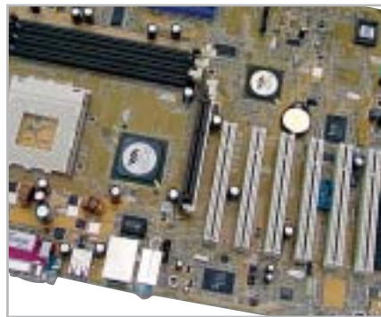
La tecnologia FastStream 64 avvicina le prestazioni dei sistemi Dual Channel senza richiedere coppie di moduli Ram
