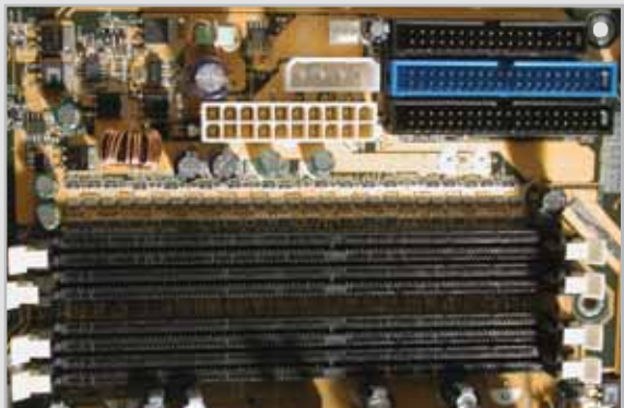
La massima memoria indirizzabile dal Granite Bay ammonta a 4 Gb, in virtù dei quattro zoccoli per moduli Ddr
