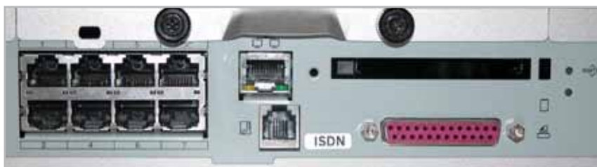
Il retro del dispositivo: sono presenti otto porte switch, una porta parallela per il server di stampa, lo slot per la schedina Wi-Fi e il connettore Isdn
