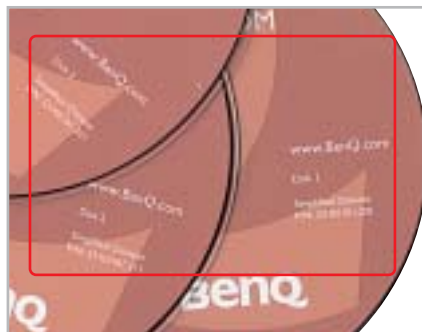
4 Il Cd di ripristino di Windows funziona solo sul computer con cui è stato venduto e diventa inservibile quando si cambia scheda madre
