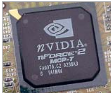
Una caratteristica del chipset nForce 2 è l'integrazione di un sottosistema audio compatibile Dolby Digital 5.1
