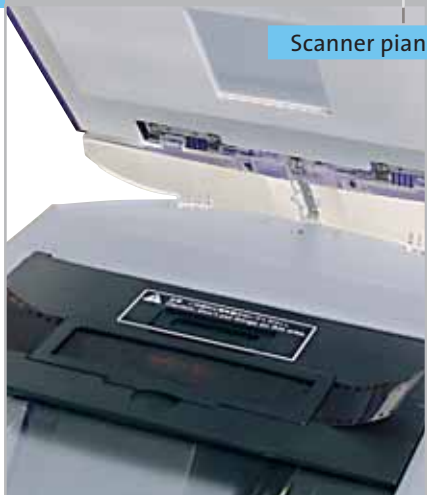
L'area di scansione del CanoScan D1250 U2F è limitata a un solo fotogramma
