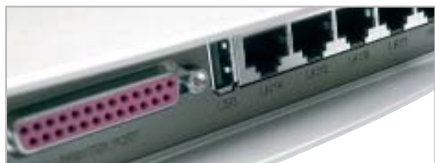
Sul retro dell'unità sono presenti quattro porte Ethernet RJ-45
