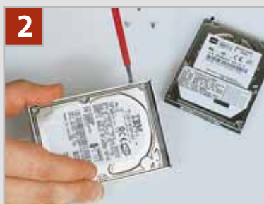
2 Sostituzione del telaio: svitare tutti i lati, l'adattatore dal vecchio drive e montarli sul nuovo disco
