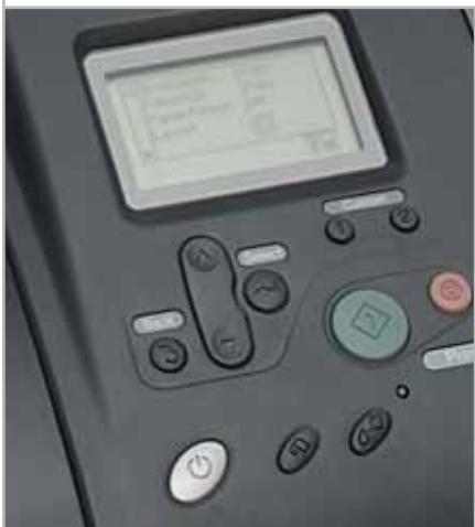
Il display mostra non solo le opzioni di stampa quando si lavora con il pc, ma dà anche istruzioni complete per la sostituzione delle cartucce
