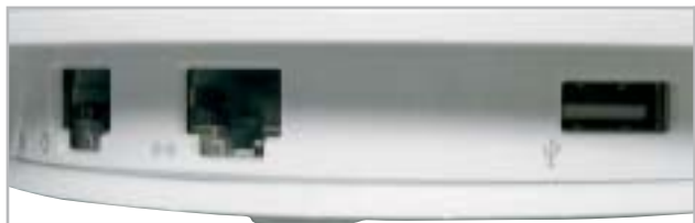
Il gateway di Apple presenta una sola porta Ethernet
