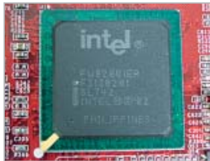
Il chip di gestione dell'I/O ICH5R gestisce il funzionamento dei dischi fissi in modalità Raid 0 e Raid 1
