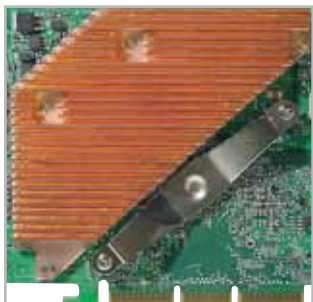
Un'aletta passiva provvede a raffreddare i chip di memoria saldati sul retro della scheda
