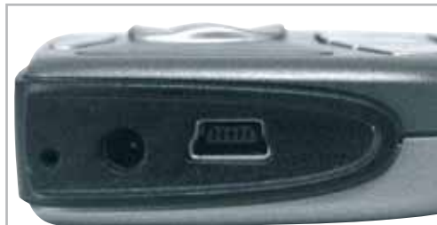
Nokia N-Gage si collega al pc tramite una porta Usb posizionata nella parte laterale inferiore del telefono
