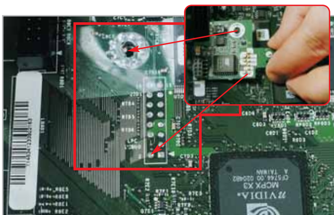
3 L'installazione della rondella distanziatrice è indispensabile per una corretta installazione del chip Matrix
