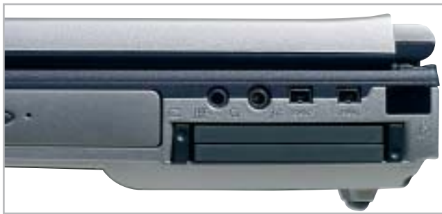
Doppio slot Pcmcia per il modello L3100 di Asus
