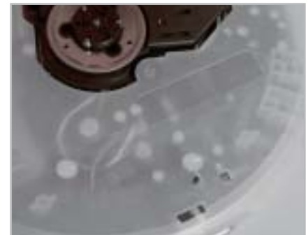
La plastica trasparente impiegata sul Waitec Glam lascia intravedere l'elettronica del lettore
