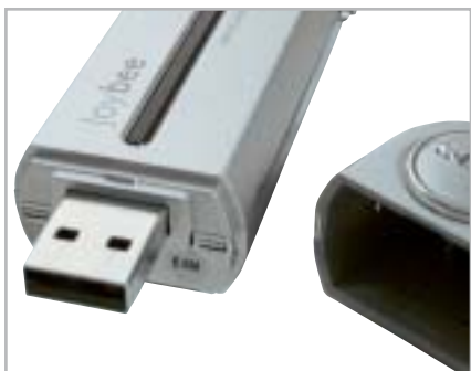
Il connettore Usb del lettore JoyBee di BenQ è protetto da un coperchietto asportabile
