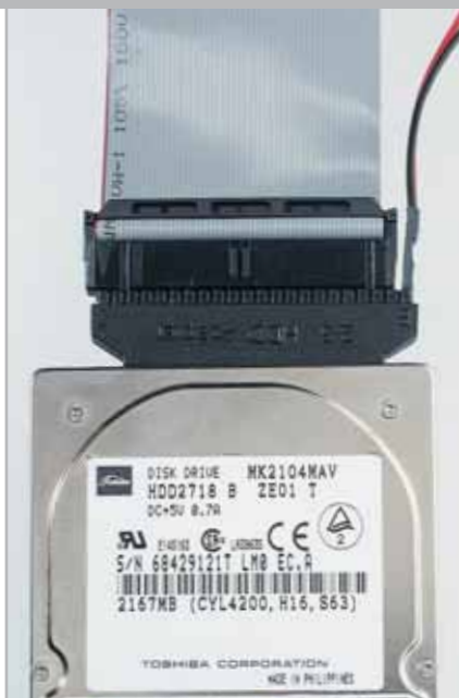
20 Un semplice adattatore permette di collegare il disco fisso del notebook a una qualsiasi porta Ide di un altro pc
