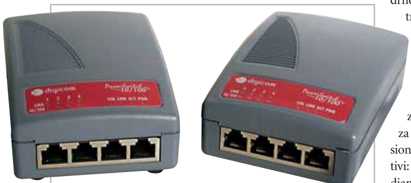
Fino a quattro pc o altri dispositivi di rete possono essere collegati contemporaneamente a ciascun PowerSwitch
