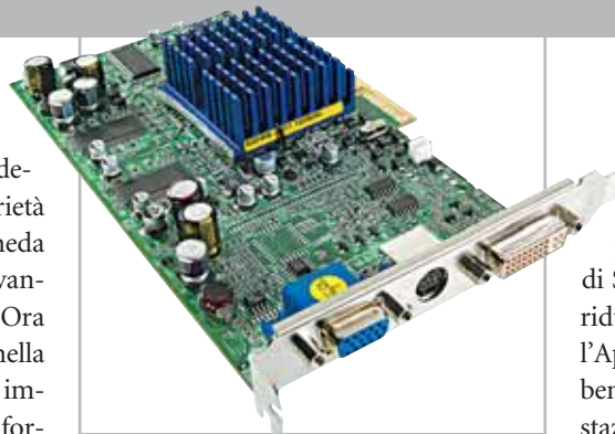
25 Invece di una rumorosa ventola, per la Radeon 9000 Pro basta usare un raffreddatore passivo
