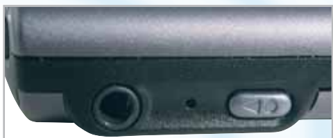
Un pulsantino posto di lato permette di impiegare il Tungsten come registratore digitale di appunti vocali
