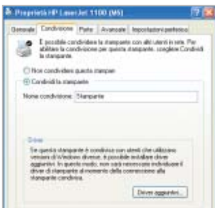
5.1 La stampante può essere collegata a un pc della rete e resa accessibile attraverso i servizi di Condivisione
