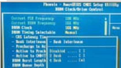
Ram più veloce attivando la modalità Interleave nel Bios
