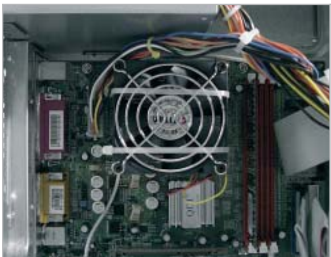
Cinture di sicurezza per il dissipatore utilizzato sul pc di Runner: una intelligente soluzione che impedisce sganci rovinosi durante i trasporti
