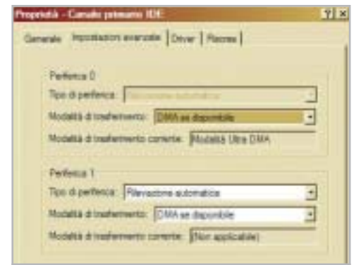
3 Per ottenere prestazioni ottimali è fondamentale attivare la modalità Ultra-Dma del disco fisso
