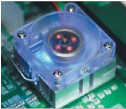
L'estetica conta più del silenzio per EpoX: sarebbe bastato un dissipatore passivo per il chipset. Un buon suggerimento per gli amanti del modding
