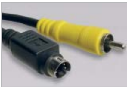
A sinistra il connettore nero mini-Din a 4 poli, a destra lo spinotto Rca
