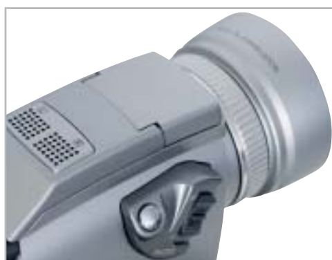
Il microfono stereo collocato sulla parte superiore dell'apparecchio non garantisce una buona direzionalità
