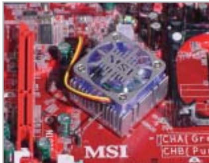
Il dissipatore attivo sulla MSI 865P Neo2 usa una ventola colorata, con luce led
