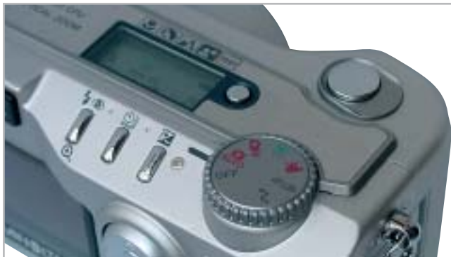
Le indicazioni riportate sul piccolo display a cristalli liquidi della Dimage S414 consentono di fare a meno del visore a colori, aumentando così la durata delle batterie
