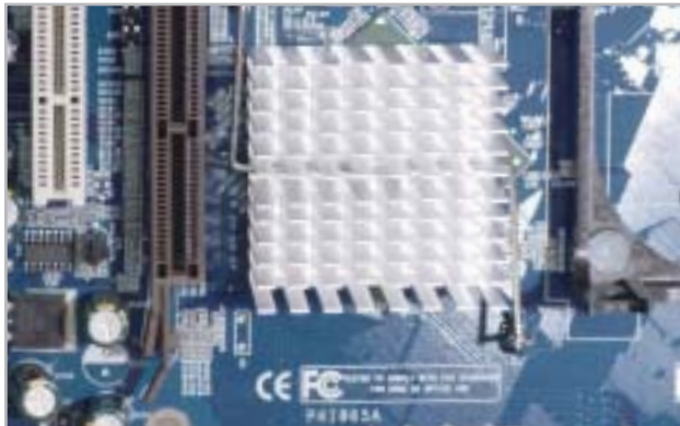
Sulla QDI P4I865 la sezione north bridge è raffreddata da un comune dissipatore passivo
