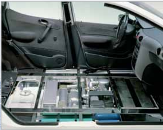
Il sistema completo di celle a combustibile installate sul prototipo Mercedes-Benz Classe-A "F-Cell"
