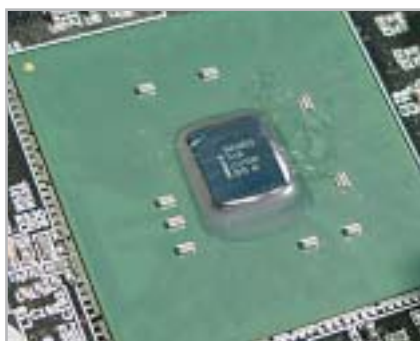
Il chipset 845 è stato a lungo un cavallo di battaglia di Intel: è stato prodotto in una dozzina di varianti
