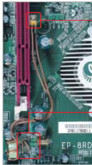
5a Trimmer potenziometrico: permette di dosare finemente la tensione di alimentazione
