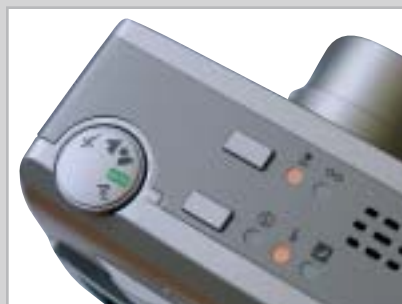
L'accensione di due led dedicati indica l'impostazione corrente per la messa a fuoco e il funzionamento del flash
