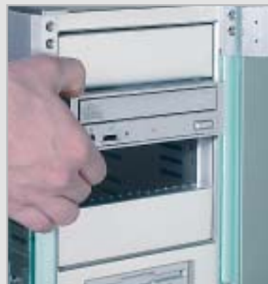
Il masterizzatore di Dvd non dovrebbe essere montato nell'alloggiamento superiore
