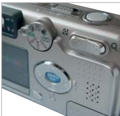
Sono sufficienti queste minuscole sporgenze sul dorso della fotocamera Samsung per rendere più salda la presa
