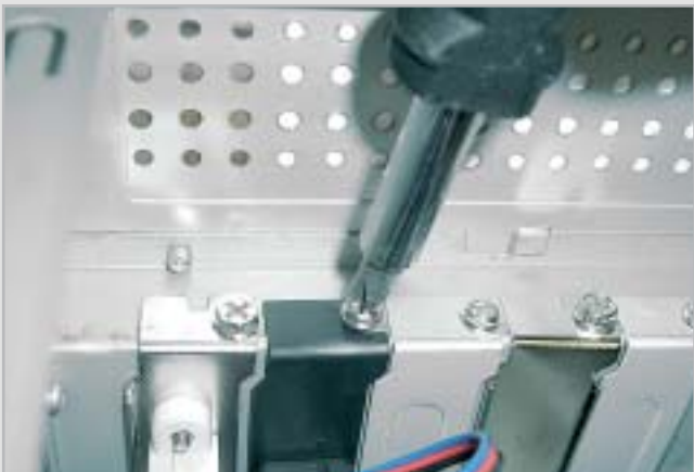
4 Dopo aver effettuato le connessioni elettriche, il regolatore del regime di rotazione della ventola può essere posizionato in uno degli slot posteriori
