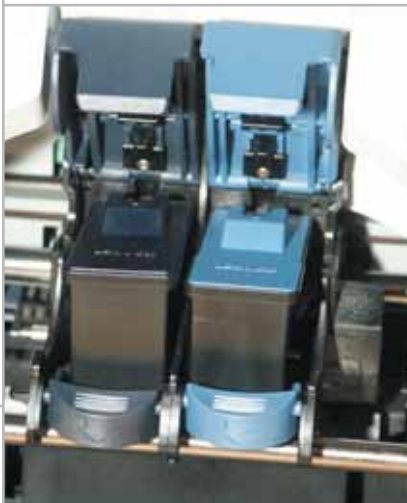
Un tocco sul pulsante e si aprono i coperchi delle cartucce d'inchiostro, facili da estrarre e sostituire
