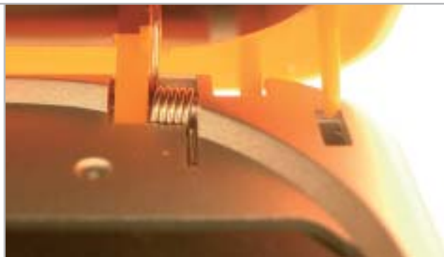
Le parti in plastica e la meccanica del lettore Verbatim sono piuttosto fragili
