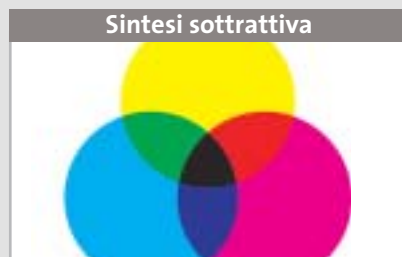
Cmyk: nelle immagini a stampa i tre colori si sovrappongono al bianco del foglio per creare le sfumature
