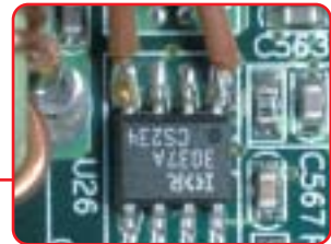
5b Grazie al trimmer si può operare con frequenza di sistema (Fsb) di 400 MHz senza problemi
