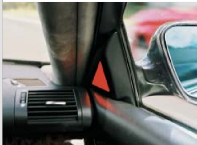
La spia luminosa segnala pericolo: il sensore ha rilevato un altro autoveicolo nell'angolo visivo morto
