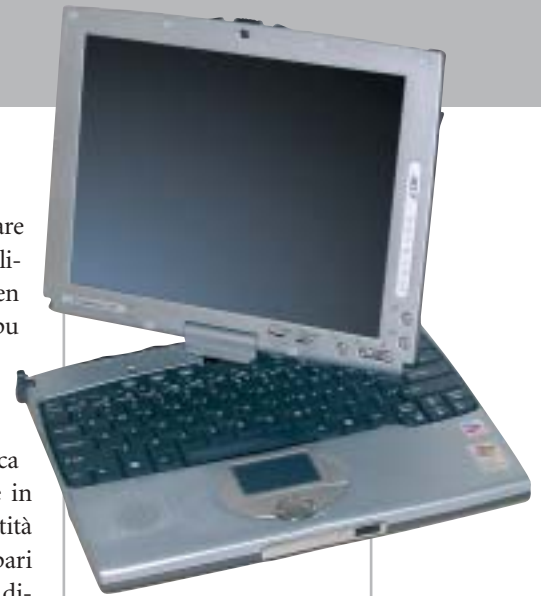
La rotazione del pannello Lcd trasforma l'Acer C110 in un Tablet Pc
