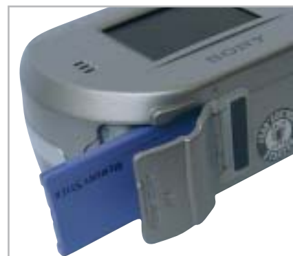
Lo scomparto per la scheda Memory Stick, il supporto per la registrazione utilizzato da tutte le fotocamere Cyber-shot di Sony
