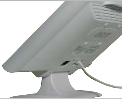
Anche inclinando il monitor Acer all'indietro di circa 45 gradi, il supporto rimane stabile
