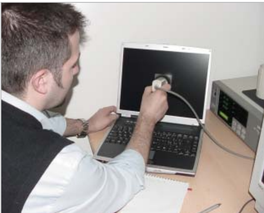
Per valutare la qualità dei pannelli Lcd sono state eseguite misure con un fotometro
