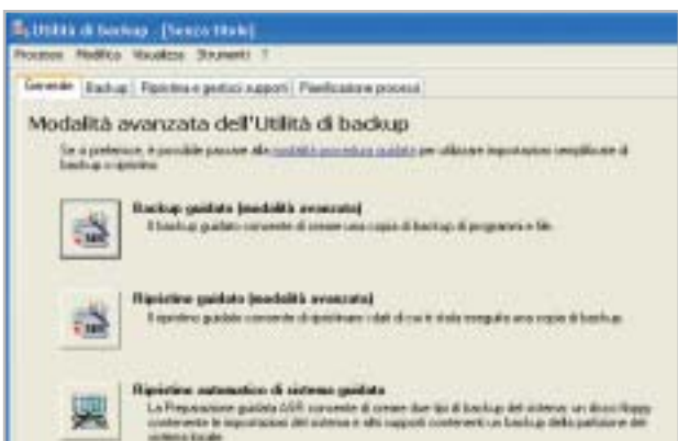
La finestra iniziale dello strumento di backup di Windows XP: il ripristino automatico di sistema, nonostante il nome possa trarre in inganno, è una particolare procedura di backup per salvare lo stato del proprio pc
