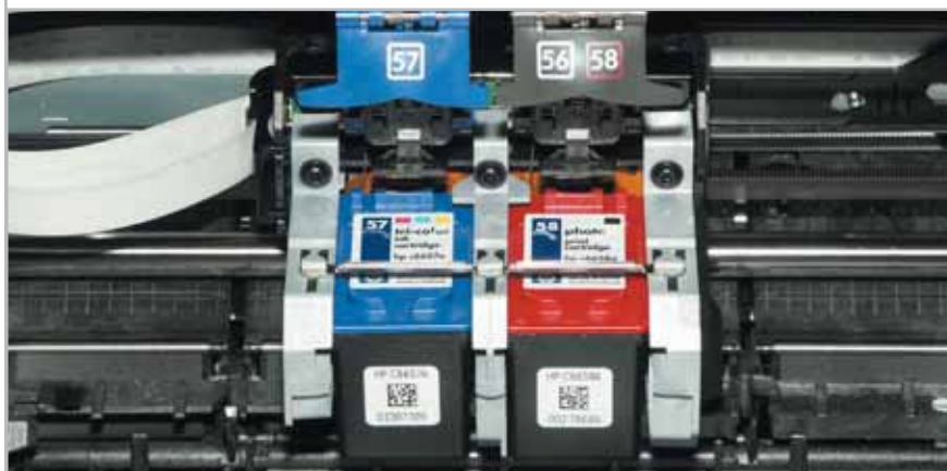
Le nuove cartucce d'inchiostro sono molto più piccole di quelle della serie 900 e la loro sostituzione è un po' più complicata
