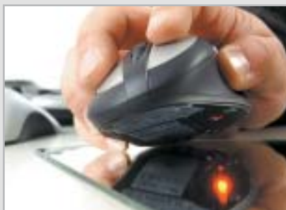
I limiti della tecnologia ottica sono evidenti se si utilizza il mouse su una superficie riflettente
