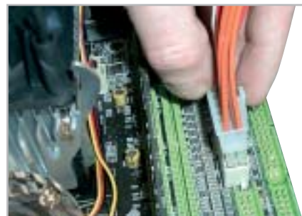
8 Alimentazione della scheda madre: ricordatevi di innestare anche il connettore supplementare per il P4
