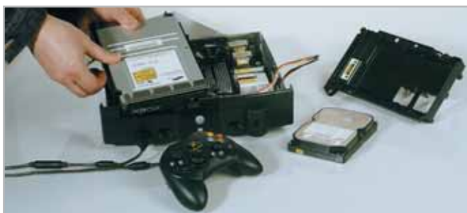
1 Dopo aver rimosso le sei viti Torx, si può rimuovere il coperchio dell'Xbox, quindi smontare il drive
