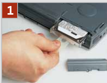
1 Smontare il disco fisso: una volta tolto il coperchio, il disco fisso può in genere essere rimosso facilmente
