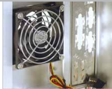
Ventola posteriore per la dissipazione di calore sul Cooler Master ATC-210
