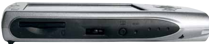
Sull'Axim X5 sono presenti sia uno slot CompactFlash sia uno per moduli Secure Digital/Mmc
