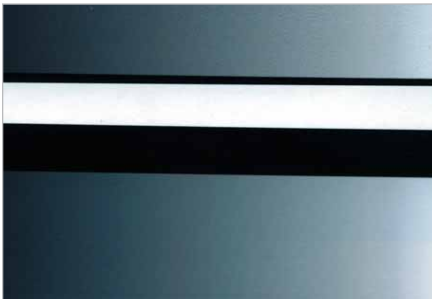
8 Incredibile, ma vero. Le due stampe raffigurate qui sopra provengono entrambe dalla medesima stampante, alla stessa risoluzione: una volta con stampa bidirezionale, l'altra senza
