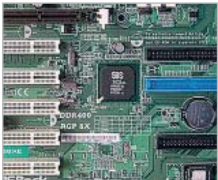
Il chipset SiS 748 utilizza il sistema Hyperstreaming per aumentare la velocità di scambio dei dati sul bus
