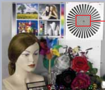
Scanner piano a 1.600 dpi: a causa della bassa risoluzione le linee al centro si confondono e sui bordi obliqui compaiono scalettature
