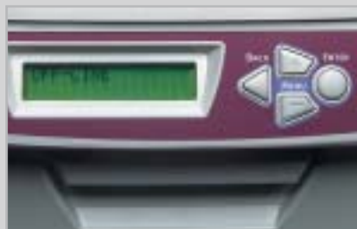
Con il display e i tasti si può gestire la stampante OKI anche localmente, senza il pc
