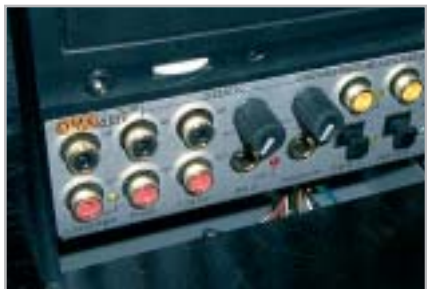
6 Il box d'espansione della Terratec DMX 6Fire va installato in modo da lasciare spazio per il passaggio dei cavi
