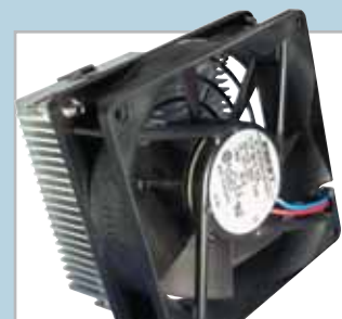
Diminuendo la tensione positiva della ventola, se ne può ridurre velocità e rumore
