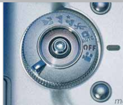
Kodak EasyShare LS443: dettaglio della ghiera di selezione della modalità operativa
