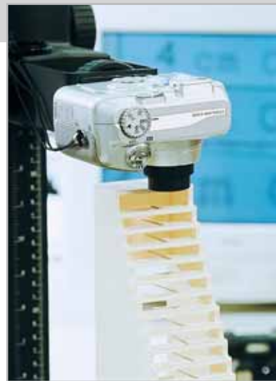
La scala per le macro di CHIP: con questo apparecchio di misura della CNC abbiamo valutato le capacità di riprese macro delle fotocamere
