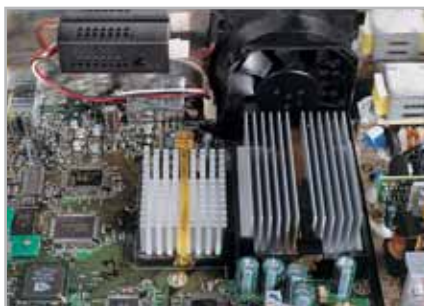
23 Il potenziometro Zalman Fan-Mate 1 permette di ridurre la velocità della ventola della Xbox quando serve
