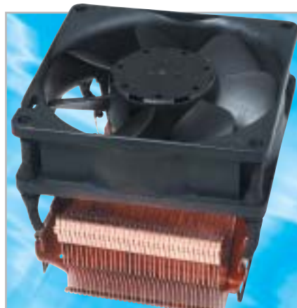
Una tecnica asiatica basata sull'uso del rame (Thermalright) combina il corpo di raffreddamento MR Vario con la ventola senza produrre vibrazioni
