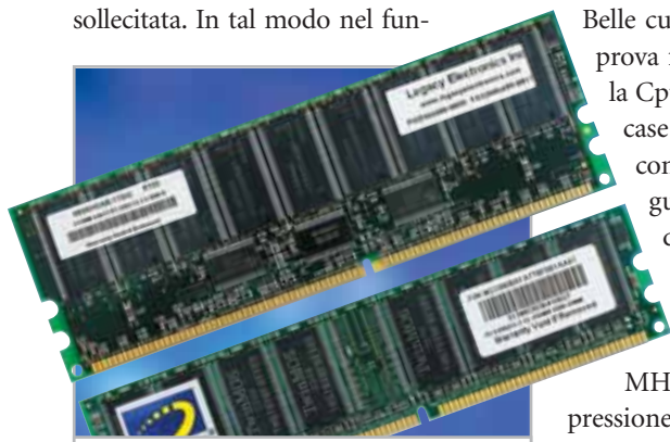
I moduli Buffered (sopra), detti anche moduli Registered, costano quasi il doppio di un normale modulo Ram non bufferizzato (sotto)
