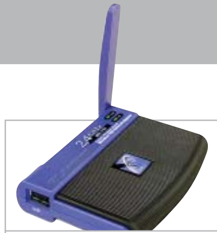
3.3 Per collegare un pc alla Wlan occorre una ricetrasmittente. Nella foto un modello esterno con interfaccia Usb
