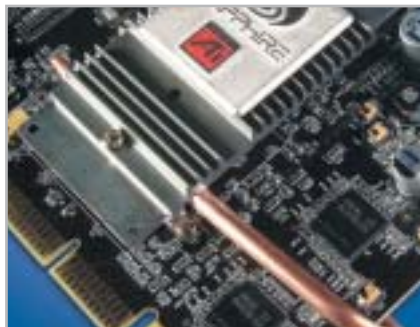
La Sapphire Radeon 9600 Pro Ultimate Edition con raffreddatore passivo è decisamente silenziosa
