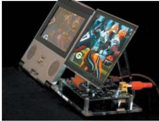
Il confronto diretto fra un display Lcd (a sinistra) e uno Oled (a destra), ben visibile da ogni angolo visuale e brillante, dimostra uno dei punti di forza della nuova tecnica
