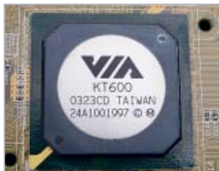
Il KT600 è l'evoluzione del KT400A: sono così simili da poter essere montati sulla stessa piastra logica
