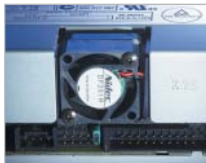
Il masterizzatore Dvd di Asus è l'unico a essere dotato di una ventola: gli altri ce la fanno anche senza dissipatore
