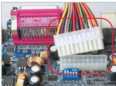
Un connettore di alimentazione difettoso può addirittura danneggiare irrimediabilmente l'alimentatore del pc
