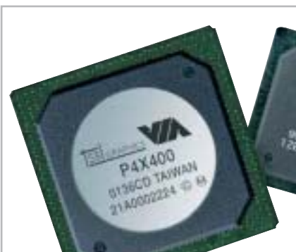
Il bus di collegamento V-Link utilizzato da VIA per il chipset P4X400 è, sulla carta, più veloce della soluzione scelta da Intel
