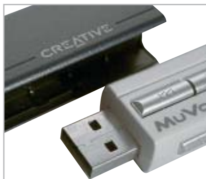
Il Creative Muvo si scompone in due parti per poter essere utilizzato anche come flash drive
