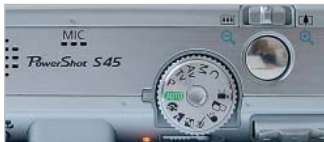
Il selettore rotante della Canon PowerShot S45 consente di scegliere fra una dozzina di modalità di esposizione diverse
