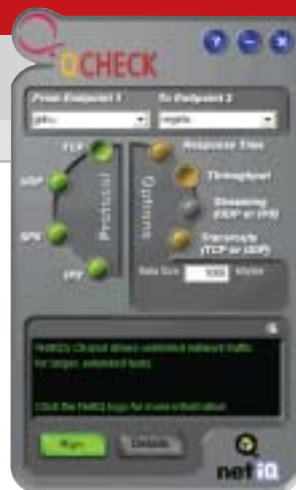
QCheck misura la velocità (Throughput) o il tempo di accesso (Response Time) della rete tra due computer specificati (Endpoint 1 ed Endpoint 2)
