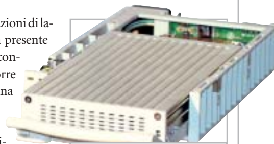
Il kit RH-32 trasforma i dischi Eide in Serial Ata
