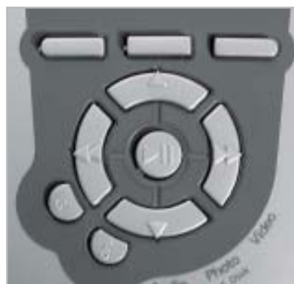
La pulsantiera a croce permette una comoda navigazione all'interno del ricco menù del modello Archos
