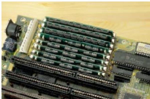
Mieszanka RAM-ów: różnych modułów pamięci nie należy ze sobą zestawiać, mimo iż w praktyce takie mieszanki działają – patrz TIP nr 4
