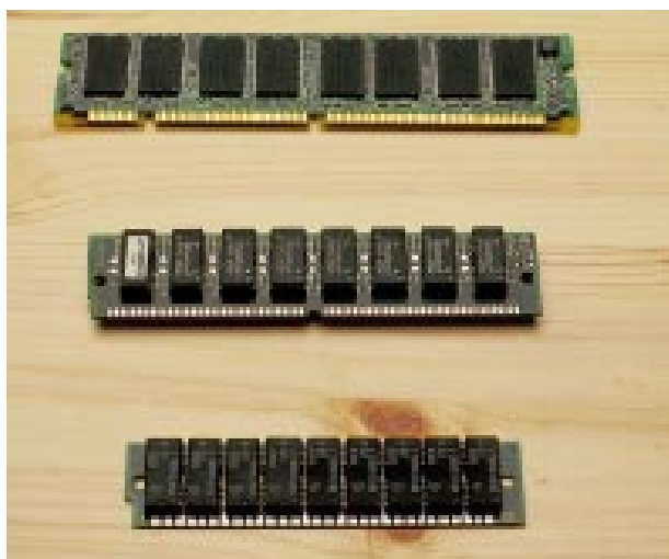
Moduły pamięciowe: w kierunku od dołu do góry widzimy 32-stykowy SIMM, 72-stykowy PS/2 i 168-biegunowy DIMM. Pamięci SIMM nie są już dzisiaj stosowane
