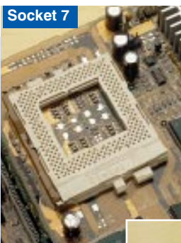
Socket 7 Gniazda CPU: każda klasa procesorów wymaga odpowiedniej płyty głównej, wyposażonej we właściwy typ gniazda. Najpopularniejsze obecnie oprawy to Socket 7, Socket 8 i Slot 1.
