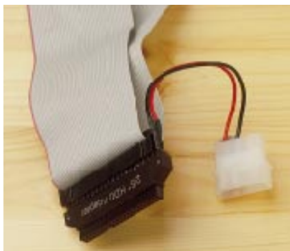
Pośrednik: adapter pomiędzy standardowym kablem IDE zwykłego peceta i dyskiem twardym notebooka umożliwia łatwe przeniesienie danych
