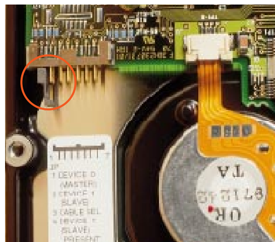
Pan lub sługa: przed zamontowaniem dyski ATA muszą za pomocą zworek zostać skonfigurowane jako Master lub Slave
