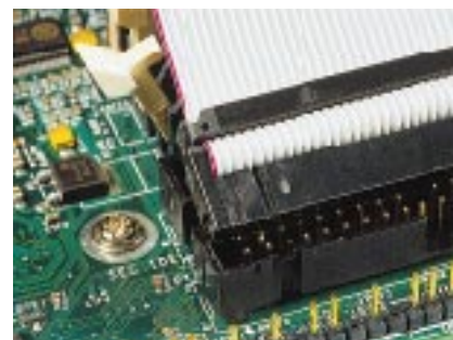
Akribisch: Auch Verpolungsschutz und Beschriftung auf der Hauptplatte zählen.
