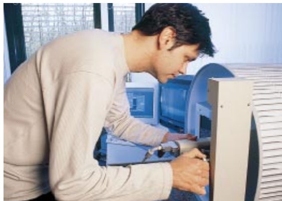
Monitortest: Links wird die Grundhelligkeit für die Konvergenz-Messung justiert. Rechts ermittelt die CCD-Kamera von Minolta den Konvergenz-Fehler.
