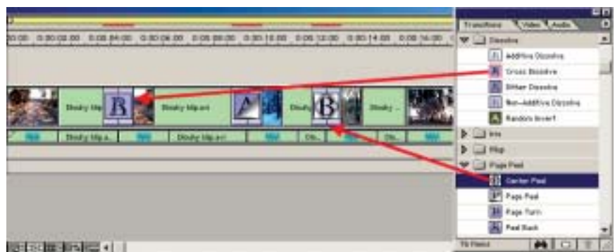
Obr. 18. Přechody se vkládají jednoduchým přetažením do časové osy.
