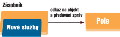
Obr. 4. Rozšíření či změna API knihovny třídy pomocí vkládání je o něco složitější, zato nabízí mnohem vyšší flexibilitu.
