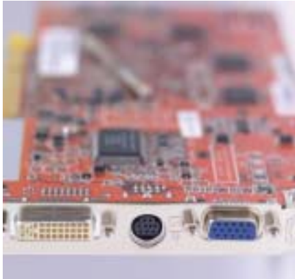
Typické výstupy grafické karty – DVI-I, S-Video a D-Sub (VGA)
