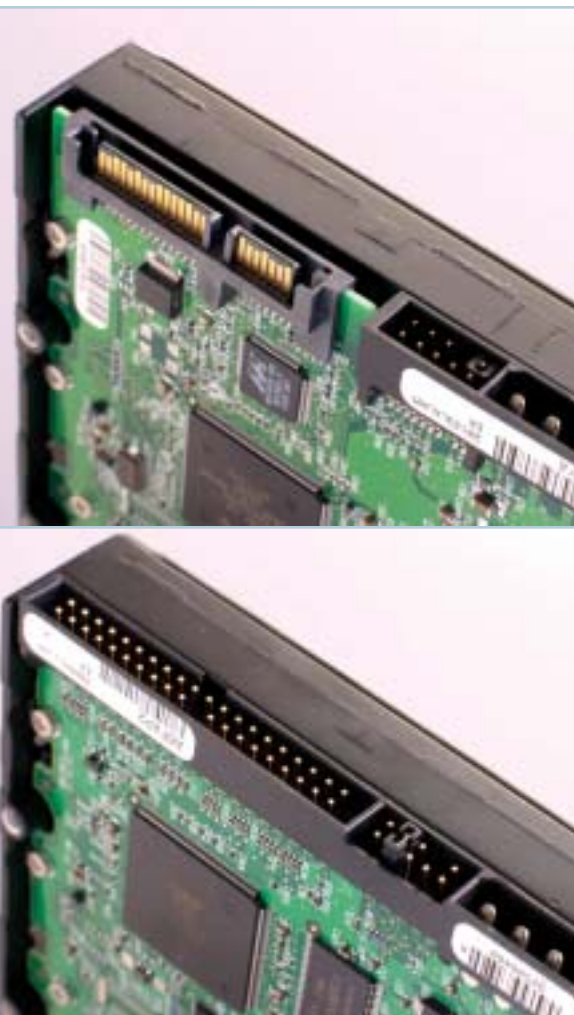
Disky s rozhraním SATA jsou díky mechanické jednoduchosti a vyšší rychlosti na postupu – vytlačují rozměrné ploché kabely paralelního disku ATA (dole).
