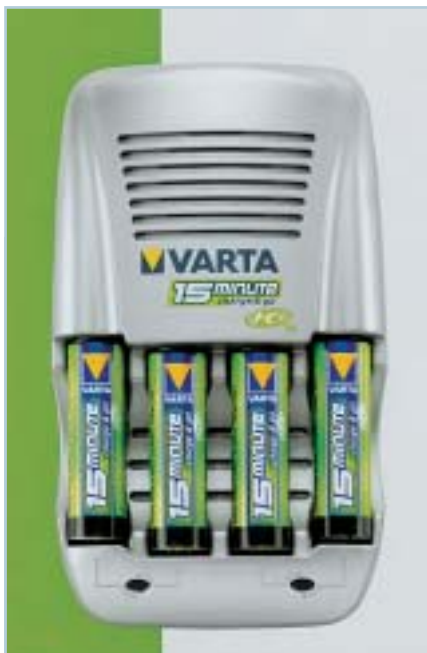
Nová ultrarychlá nabíječka: Model „15 Minute Charge & Go“ od Varty plně natankuje čtyři NiMH články (2000 mAh) za pouhou čtvrt hodinu.
