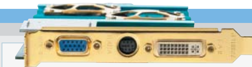
Pouze s adaptérem: Tato karta Leadtek zpřístupňuje TV vstupy a výstupy pouze díky svým dodávaným kabelům.
