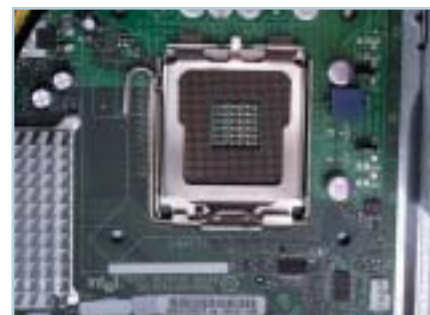
Procesory Intel mají nové označení (používá se tříčíselná kombinace) i umístění – piny má tentokrát patice (Socket 775) a nikoli procesor. Výrobci základních desek z toho nadšení nejsou.
