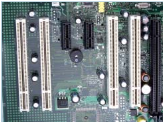
Nová sběrnice PCI Express (hnědé sloty – delší je označen jako PCI Express 16x, kratší PCI Express 1x) nahradí sběrnici PCI i AGP. Bude to ale nějakou dobu trvat.
