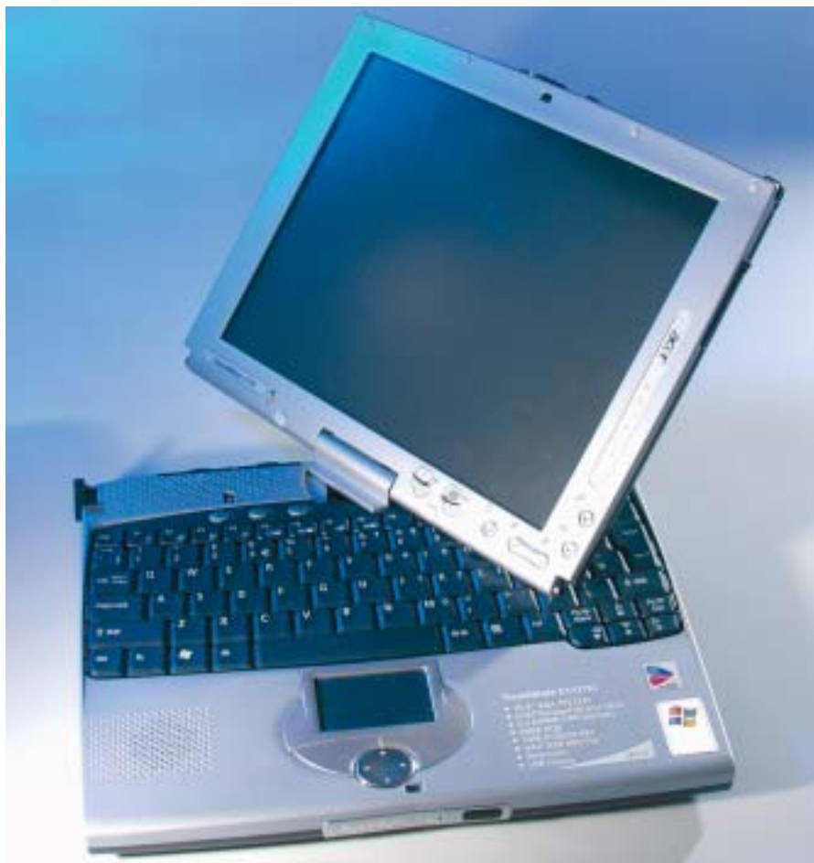
Notebook Acer TravelMate C110 můžete předělat na Tablet PC. Uvolníte displej, pomocí kloubu ho otočíte, zajistíte, vezmete tužku (je ve víku) a můžete začít psát.
