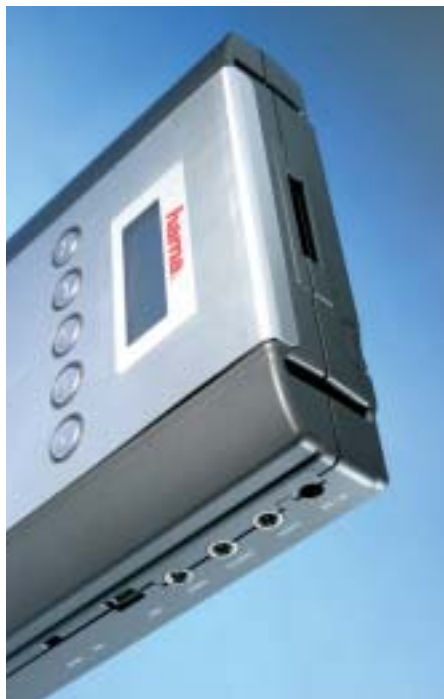
USB, video i zvukové konektory jsou soustředěny na pravém boku.
