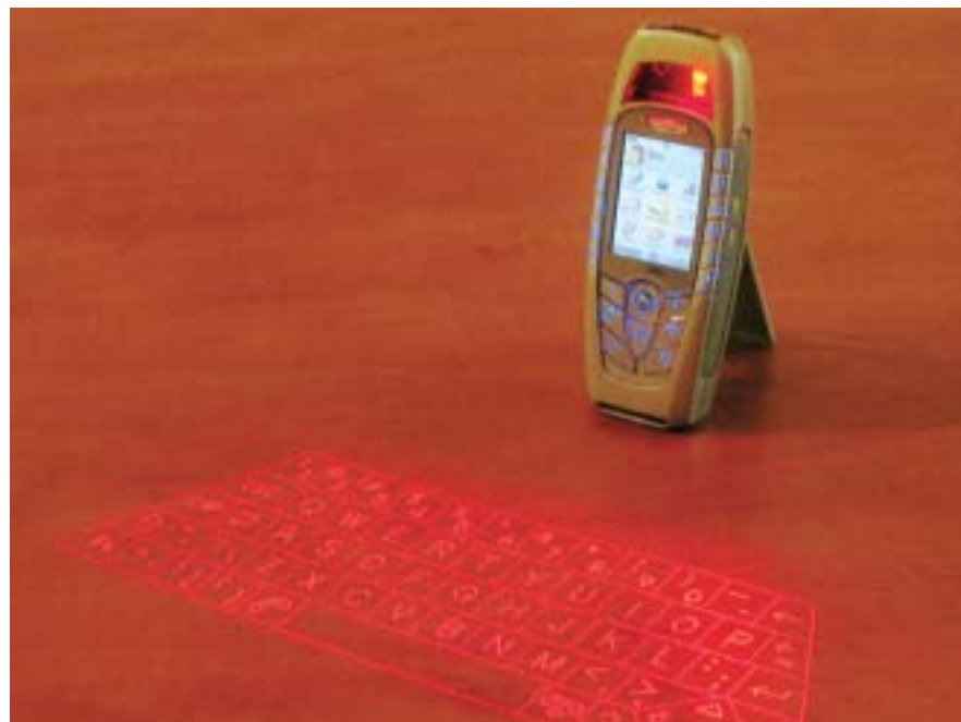
Siemens SX1 s adaptérem virtuální laserové klávesnice pro snazší zadávání textu.
