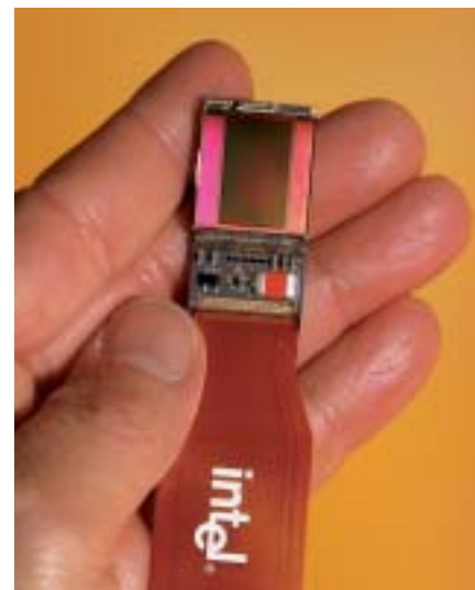
Čip s vysokým rozlišením: Aktuálně vyráběné LCOS displeje dokáží úplné rozlišení HDTV – 1920 x 1080 obrazových bodů.
