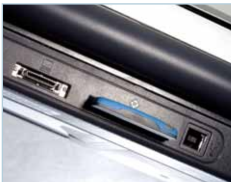
Podpora rozhraní Bluetooth je u tiskárny HP realizována formou zásuvné karty CompactFlash.
