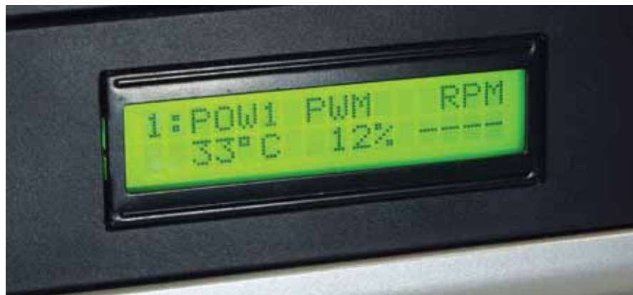
Počítače Orange & Green a CASH mají speciální modul „Termo Controller“, který sleduje teplotu a napájení komponent a reguluje otáčky ventilátorů.
