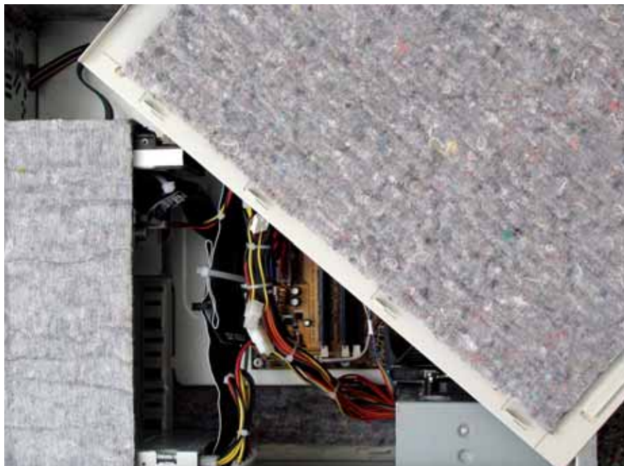
Pro ztišení počítače se mohou použít i tlumicí materiály, které by ale měly odvádět teplo, aby se počítač „neupekl“. Na obrázku je ztišený počítač Mironet.
