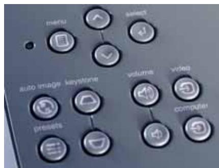
Ovládací tlačítka na projektoru. Chybí tlačítko pro vypnutí – to je jen na dálkovém ovladači.
