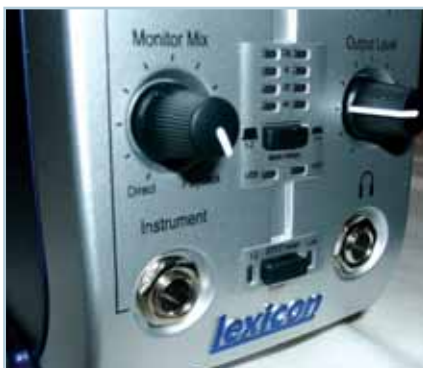
Potenciometr Monitor Mix určuje, jakým poměrem bude v odposlechu zastoupen výstup aplikace a jakým poměrem vstupy.
