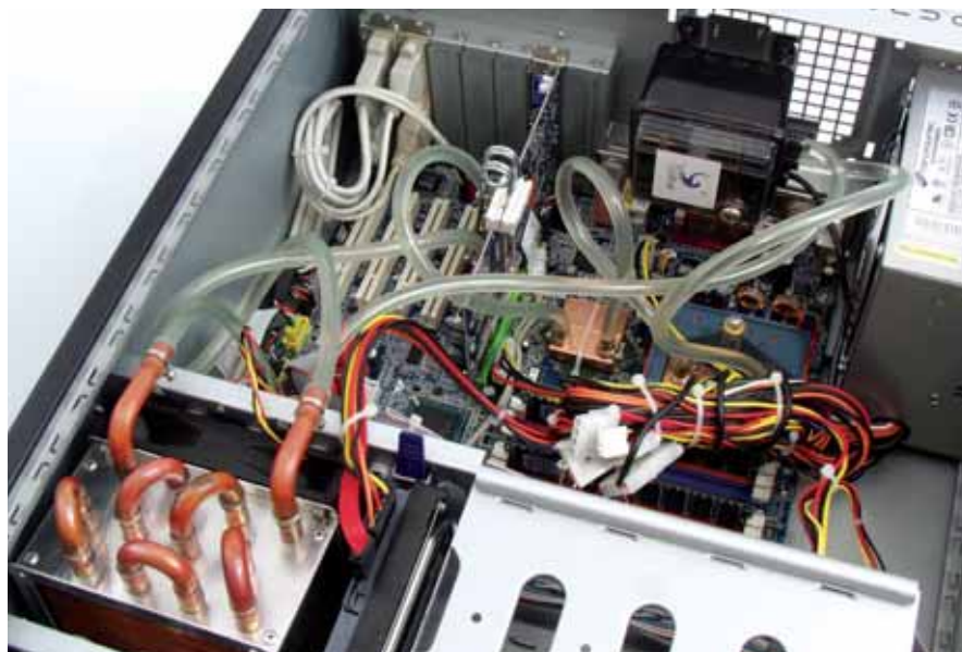
Chladit lze i vodou. Jediného „vodníka“ dodala firma ELAP. Ventilátor u chladicí jednotky byl však bohužel dost hlučný a ještě byl umístěn v přední části PC.
