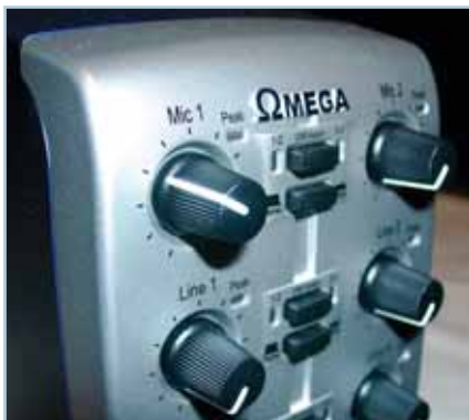
Ovládání zisku mikrofonních předzesilovačů na čelním panelu studia.
