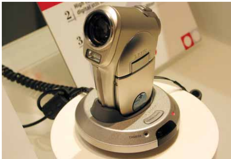
Sanyo FVD-C1: Digitální kamera zaznamenávající ve formátu MPEG-4 se stereofonním zvukem, pořizující fotografie, disponující 5,8násobným optickým zoomem a ukládající data na kartu formátu SD
