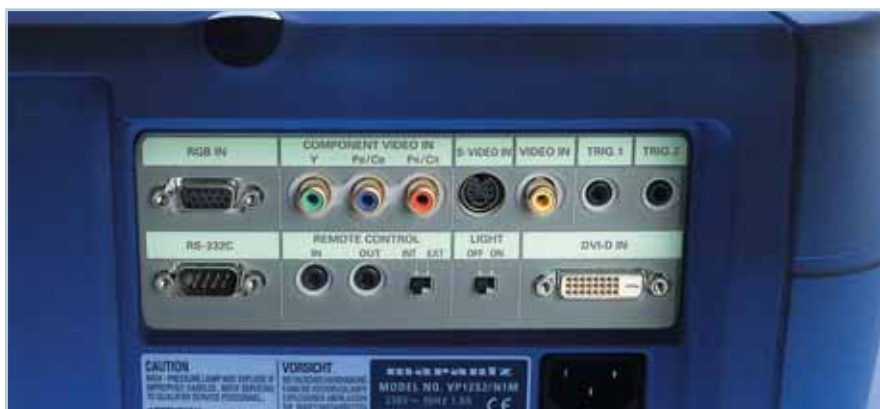
HDTV potřebuje vstup DVI nebo vstup komponentní.
