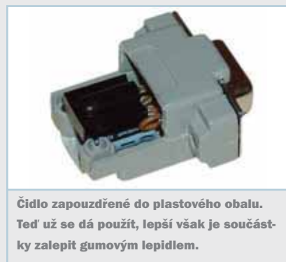
Po připojení rezistoru, Zenerovy diody, infračerveného přijímače a kondenzátoru
