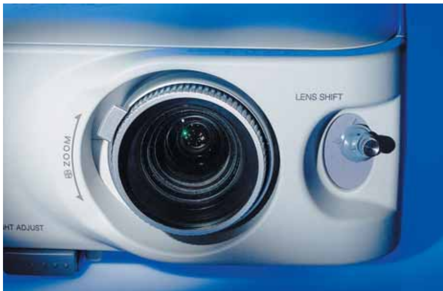
Sharp PG B10S: Jen u Sharpu se dá poloha objektivu mechanicky přestavit.
