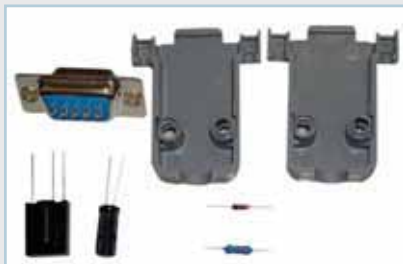
Všechny součástky potřebné k výrobě čidla
