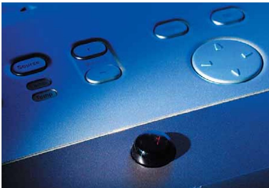
Philips bSure XG2: U Philipsu je infračervený senzor umístěn nahoře, tam se dálkové ovládání trefí vždy.
