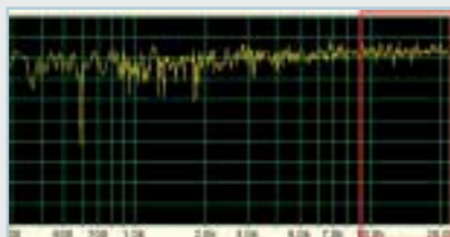
WAV: Nekomprimovaný soubor obsahuje úplný průběh frekvence bílého šumu.
