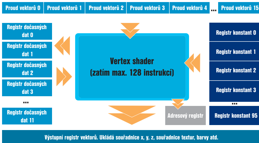
Obr. 2. Schematické znázornění architektury Vertex Shaderu
