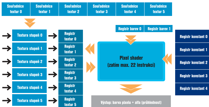
Obr. 3. Schematické znázornění architektury Pixel Shaderu
