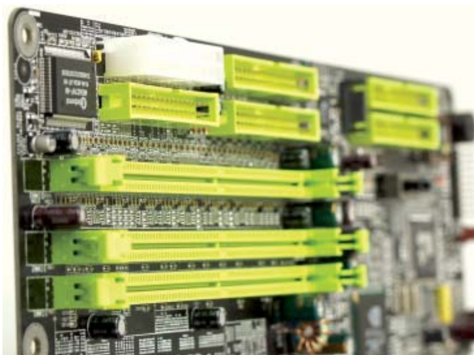
Základní desky mají většinou tři paměťové sloty a maximem jsou 3 GB paměti. Pokud chcete použít Dual Channel přístup k paměti, musíte osadit dva paměťové moduly.
