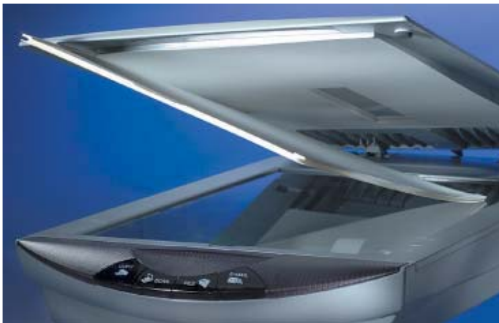
CANOSCAN 5000F: Víko prosvětlovacího adaptéru se dá těžko aretovat a někdy spadne dolů.
