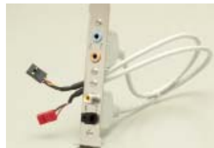
Když se všechny konektory nevejdou přímo na desku, přidává výrobce adaptér, zde například se zvukovými konektory, včetně konektoru S/PDIF.
