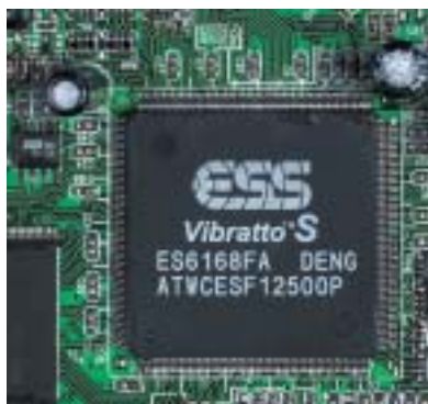
Dekódovací čipy: Vlevo dosud nepoužívanější EM8500 od firmy Sigma Designs, vpravo nový čip ESS Vibratto.
