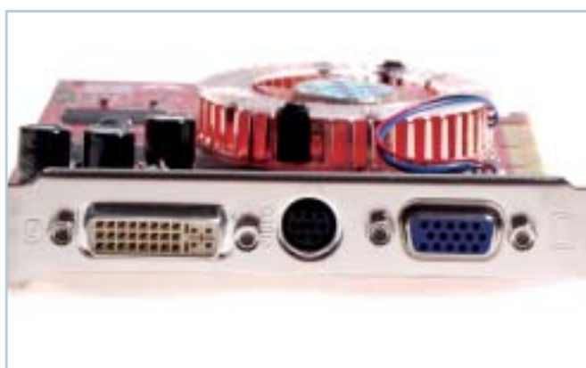
Typické konektory grafické karty – DVI-I, video a D-Sub (VGA).
