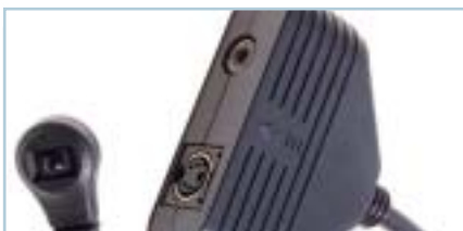
Konektory pro připojení televizoru a senzor dálkového ovladače karty MSI.
