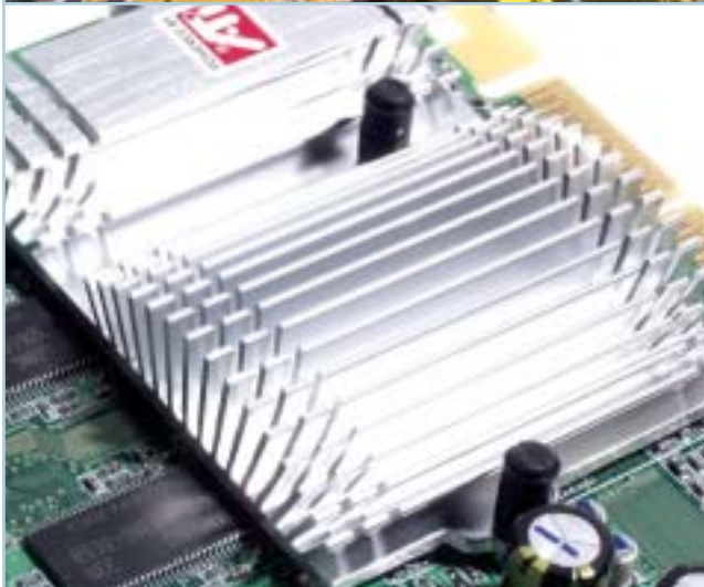
Některé karty potřebují ventilátor, jiné si vystačí s pasivním chlazením.
