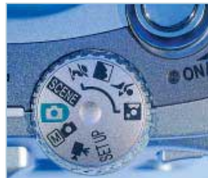
Ještě jeden volicí kroužek: I u Coolpixu 3100 od Nikonu se dají nastavit programy motivů bez přechodu do menu.
