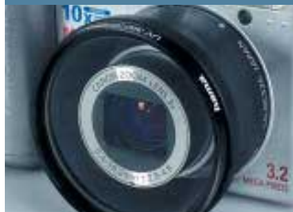
Canon A70: Instalován je adaptér pro filtry a širokoúhlé předsádky.
