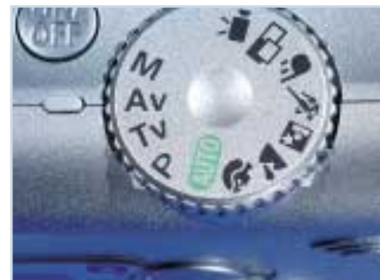
Dvanáct různých režimů: Zcela bez pomoci menu volíte u Canonu A70 důležitá nastavení pomocí otáčecího kolečka.
