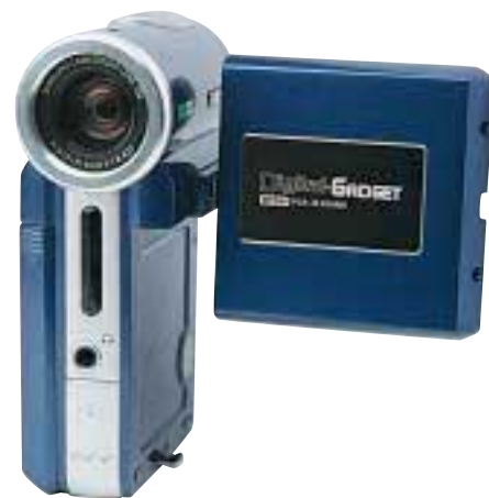
Samsung ITCAM zvládne nahrát až 66 minut videa ve formátu MPEG4, a to na interní pevný disk s kapacitou 1,5 GB. Kromě toho může být využit i ve funkci přehrávače MP3, audiorekordéru, webové kamery nebo úložiště dat.
