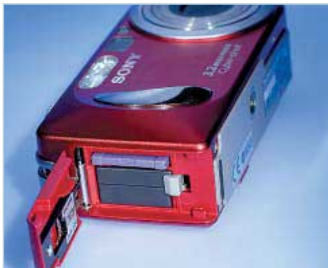
Zvednutá záklapka: Tady je u Sony DSC P8 schovaná paměťová karta a silný, nestan- dardní akumulátor Li-Ion.
