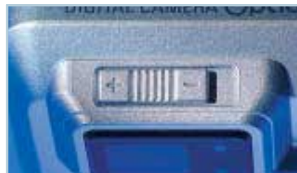
Dioptická korekce: S posuvným ovladačem mohou nositelé brýlí přizpůsobit optický hledáček Pentaxu Optio 550 od -3 do +1 dioptrie na optimální vidění bez brýlí.
