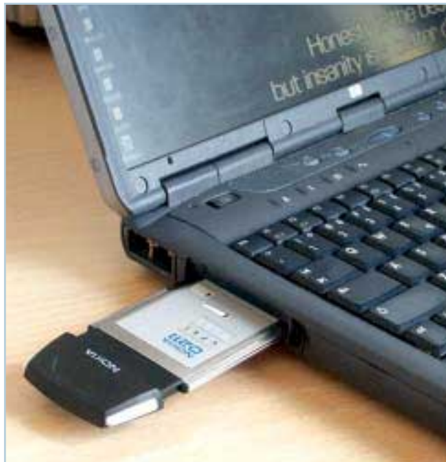
PC Card Nokia D211 kombinuje GPRS a Wi-Fi, čímž tvoří zajímavé řešení pro práci na cestách
