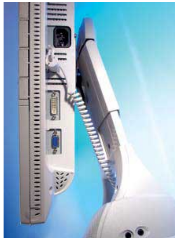
U monitoru Philips, který má displej otočný na výšku a odpojitelný podstavec, je napájení vedeno kablíčkem z podstavce.
