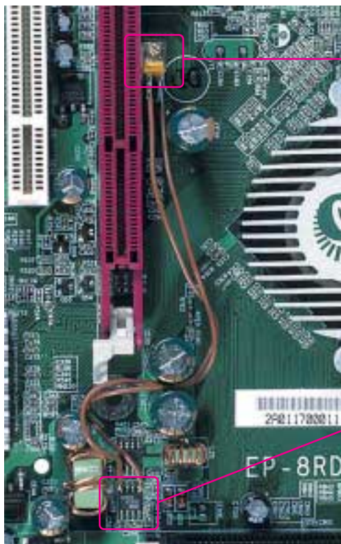
Doladovací potenciometr: Umožňuje jemné ladění provozního napětí.
