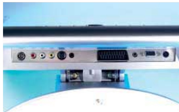
Výbava konektorů monitoru Hansol: analogový VGA vstup, zdířka pro zvukový kabel, kompozitní a S-Video videovstup, anténní vstup, konektor SCART
