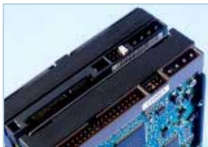
Interní disky se připojují pomocí rozhraní Serial ATA, nebo Paralel ATA (dole).
