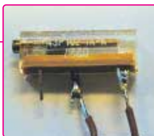
Doladovací potenciometr: Umožňuje jemné ladění provozního napětí.
