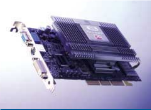
Grafická karta Sapphire Atlantis Radeon 9700 Pro Ultimate Edition je nejen výkonná, ale i tichá – má mohutný pasivní chladič.
