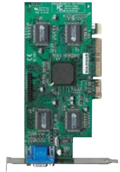
Pro formát NLX se vyráběly speciální verze videokaret.
