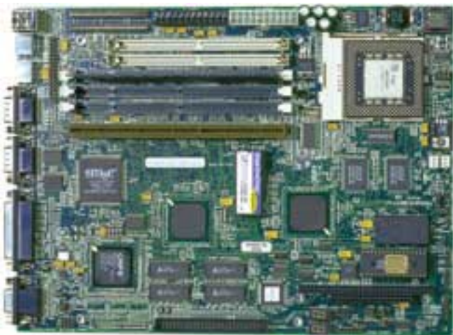
Základní deska starého formátu LPX, který se dávno stal historií. Měla menší rozměry, což byl v té době poměrně pokrok.
