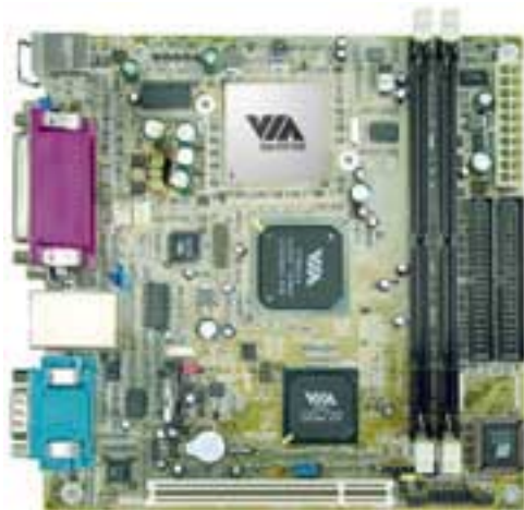
Etalon základní desky formátu mini-ITX pro platformy Eden: její rozměry jsou všeho všudy 17 × 17 cm, kdežto standardní ATX deska má rozměry 30,5 × 24,4 cm.
