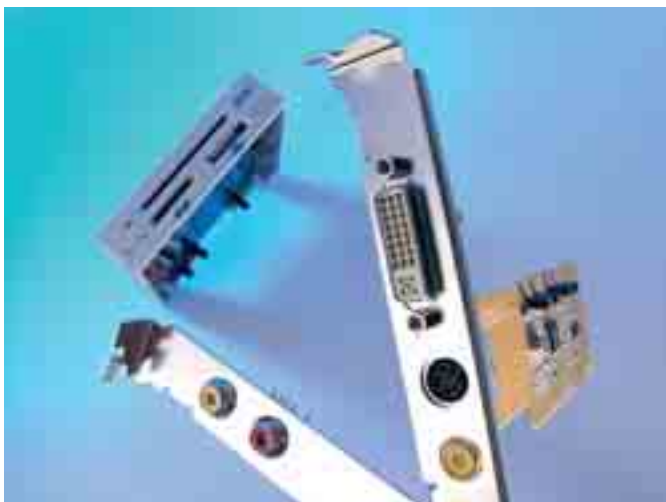
K základní desce se mohou přikoupit doplňky – čtečka karet, S/PDIF výstup a nebo ADD karta s digitálním výstupem DVI.
