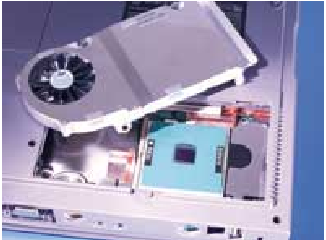
V mnoha levných notebookech se používá desktopová verze procesoru. Je levnější než mobilní, ale toto řešení má i své nevýhody – především ve vyšší spotřebě energie a z toho vyplývajících problémech s chlazením.
