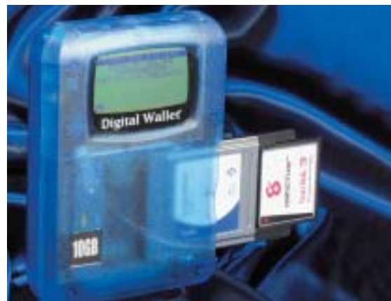
Digital wallet – adaptér paměťové karty z těla přístroje poněkud vyčnívá, pro přepravu je nutné jej vyndávat.
