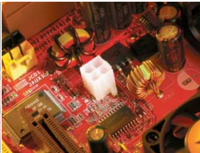
Základní desky pro Pentium 4 většinou vyžadují ještě speciální napájení pomocí konektoru označovaného jako ATX +12 V, a tedy i speciální napájecí zdroj. Deska ECS ho nemá, a tudíž se obejde i bez tohoto zdroje.
