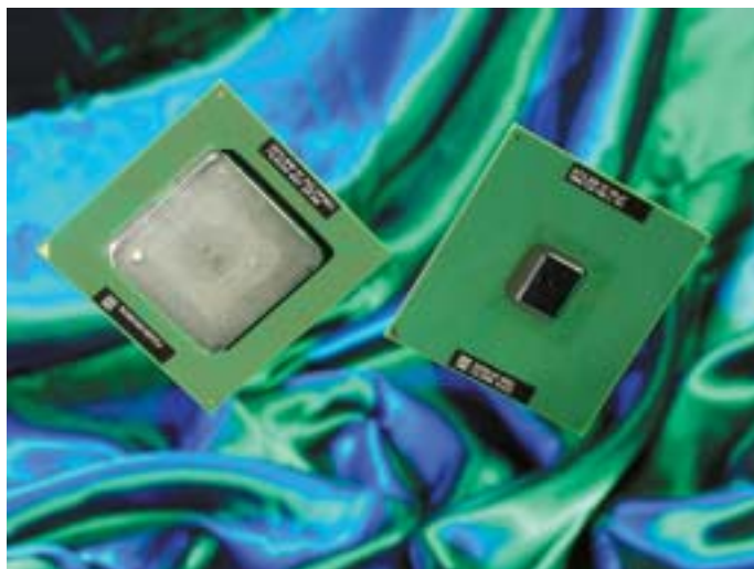
Processor Celeron 1,2 GHz má nové jádro i pouzdrění. Lepší ochranu a odvod tepla zajišťuje tzv. Heat Spreader (kovová destička na procesoru vlevo). Nalevo je obrázek procesoru Celeron s nižší frekvencí.
