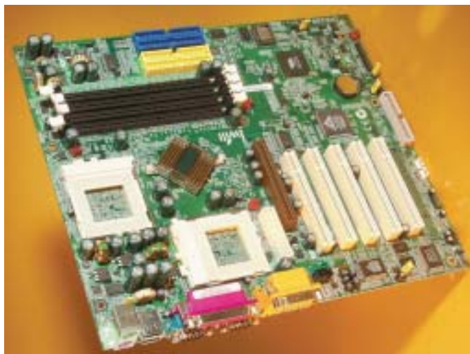
Paměti DDR a IDE RAID řadič, dva základní kameny desky Iwill DVD-266-R
