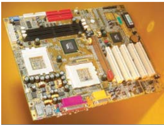
Soltek SL-68C řídí čipová sada VIA Apollo Pro 133A, k dispozici je AGP Pro a volitelně také IDE RAID řadič.
