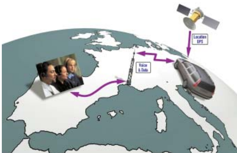
Auto je neustále pod dohledem – schéma činnosti systému VOC.
