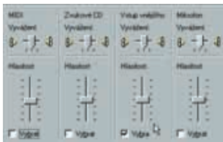
Mixážní pult: Jako zdroj záznamu aktivujte na mixážním pultu Ovládání hlasitosti vstup zvukové karty
