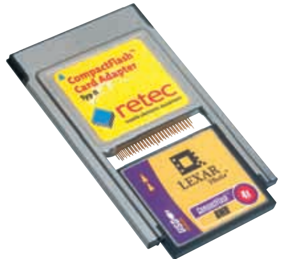
UKÁZAT ZUBY: Padesát datových vodičů u CompactFlash karty umožňuje vyšší přenosové rychlosti než sériová řešení.
