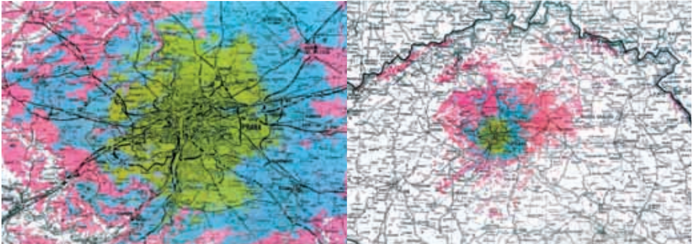
Kalkulované pokrytí zkušebním signálem (CDG) – zelená barva vymezuje zaručený příjem na prutovou anténu, šedomodrá na prutovou anténu ve volném prostoru a červená barva označuje oblasti s kvalitním příjmem na běžnou venkovní UHF anténu.
