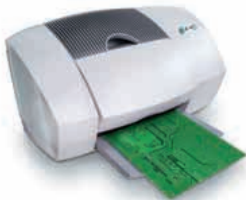
HUDBA BUDOUCNOSTI: Speciálním polovodičovým „inkoustem“ tiskne tiskárna tranzistory na fólii.
