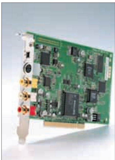
Canopus DV-RaptorRT je žhavé železko v ohni. Nabízí digitální vstupy a výstupy i real-time analogový výstup, a to vše za velmi přijatelnou cenu.
