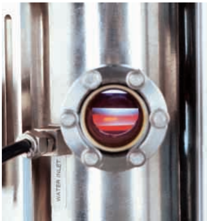
SYNTECKÉ NANÁŠENÍ DIAMANTOVÉ VRSTVY: Ocelová komora plazmového zařízení obsahuje metan a vodík. Do směsi se přivede energie, která rozloží molekuly metanu. Za intenzivního modrého světla vzniká čistý uhlík, který se sráží na žluté iridiové podložce. Vznikne vrstva z krystalů diamantu.
