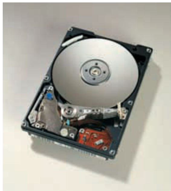
Travelstar 48GH – první disk, u něhož byla použita nová technologie AFC. Tento 2,5" disk má kapacitu 48 GB.
