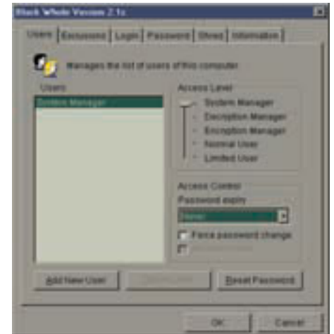
Obr. 3. Administrace uživatelů – vše podstatné lze nastavit pomocí tohoto okna.
