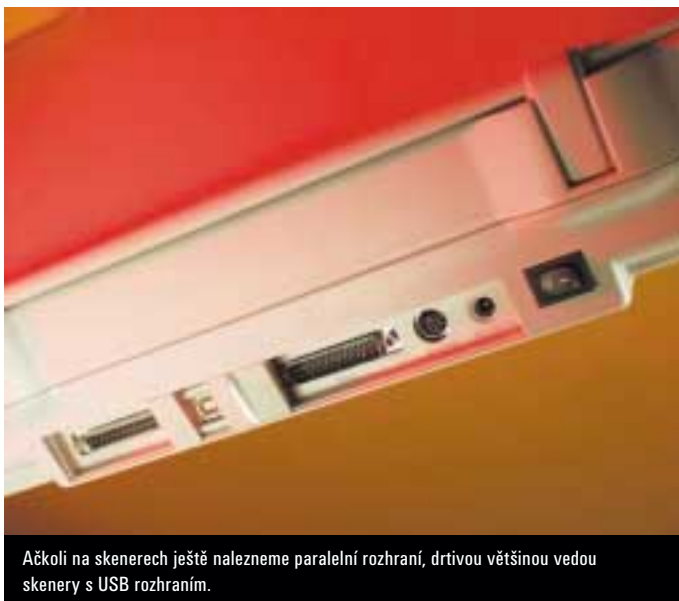
Transparentní adaptér skeneru Microtek ScanMaker 3600 Plus se připojuje přes zvláštní 15pinový konektor.
