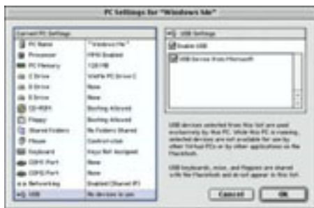
Preference Virtual PC 4 – přehledné a snadné nastavení hardwaru „virtuálních strojů“ – každý má své vlastní nastavení
