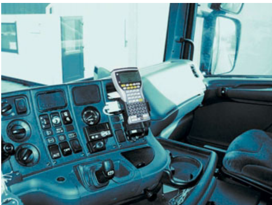
Detaily zástavby minipočítače na pracovišti řidiče vozidla
