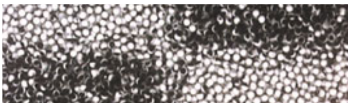
Elektronický papír se skládá z mnoha černobílých kuliček, které se otáčejí působením elektrické energie.
