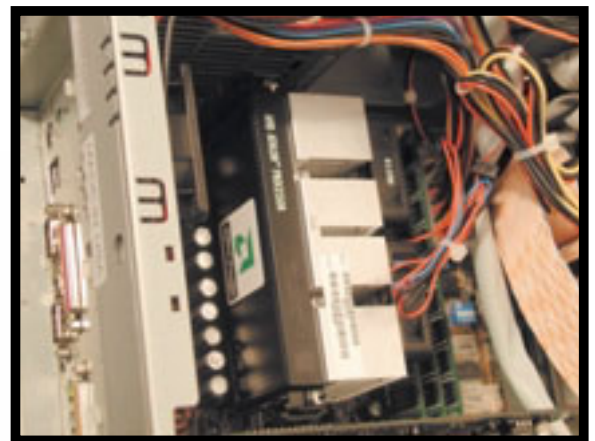
Gigahertzový Athlon vyžaduje skutečně dobré chlazení.
