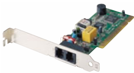
Microcom DeskPorte 56K Internal/L – interní modem s rozhraním PCI.
