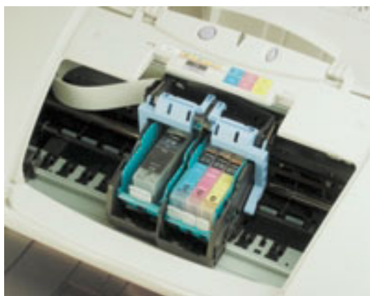
Pohled na inkoustové náplně tiskárny BJC-6500. Jsou patrné výměnné zásobníky jednotlivých inkoustů, černá tisková hlava (zelený plast) se vyměňuje za skenovací nebo fotografickou hlavu.
