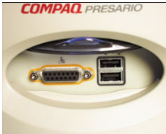
Šikovně umístěné konektory gameport a USB u počítače Compaq — pod zásuvným krytem přímo na čelní masce
