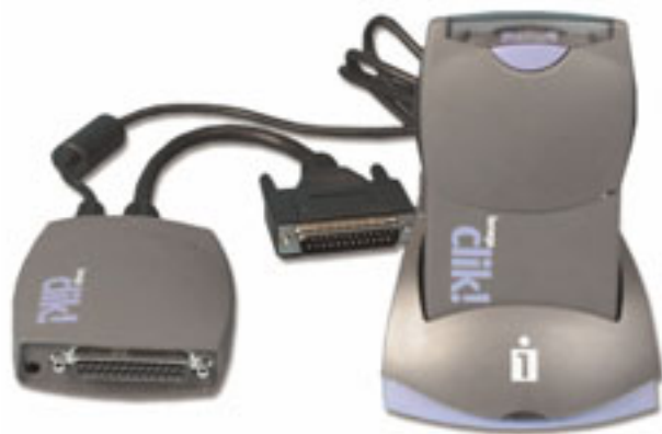
Mechanika Klik! Plus Mobile Drive ve stojánku, který se připojuje k paralelnímu portu počítače. Připojit se může i pomocí adaptéru Klik! PC Card Adapter do slotu PC Card Type II.
