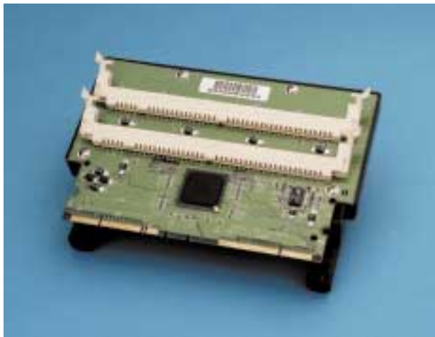
DIMM Riser card: jediná možnost, jak použít paměti DIMM ve slotech RIMM.
