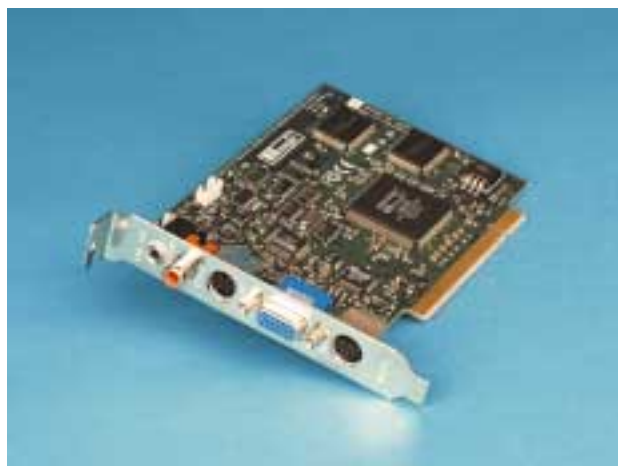
Pro přehrávání filmů na počítači je nutná buď MPEG karta (viz obrázek), nebo výkonný procesor, výkonná grafická karta a softwarový DVD přehrávač.
