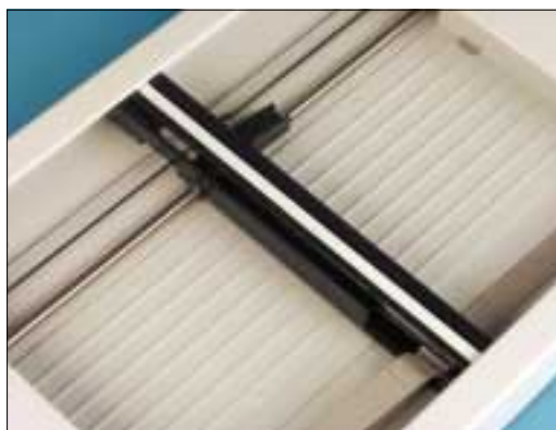
Skener, u něhož výrobce použil snímací hlavu se snímacím CIS prvkem, vychází výrazně nižší a lehčí a jeho výroba je levnější.
