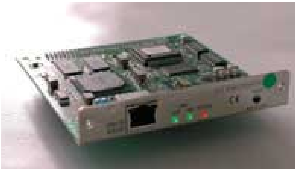
Některé tiskárny můžete po přidání interní síťové karty používat i v síťovém prostředí.
